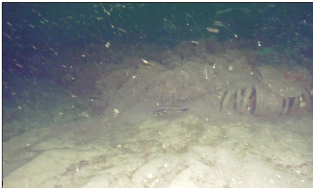
Figur 8-16. Verificering af targetet i position A17_07. Objektet på ovenstående SSS billede (Figur 8-15) er verificeret til at være et gammelt bundtrawl net.
