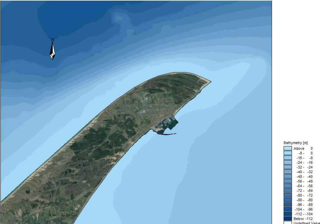
Figur 2-73. Zoom af bathymodel anvendt til simulering af sedimentspredning efter etape 3 udvidelsen er gennemført.
