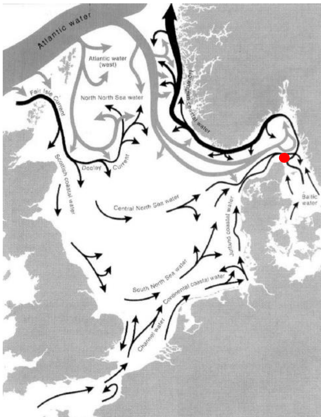
Figur 1-11. Schematisk gengivelse af netto-cirkulationen i Nordsøen, Skagerrak, samt Kattegat. Mørke pile viser strømninger i overfladen og de lyse pile viser dybereliggende strømme. Bredden på pilene indikerer styrken 17 . Skagen markeret med rød cirkel.
