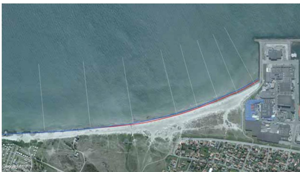
Figur 2-72. Skønnet fremtidig kystlinje optegnet i forhold til den eksisterende vist i baggrundsbilledet. Blå: Ny ligevægt. Rød: Ændringer på kort sigt hvor fremrykning nær havnen kompenseres af tilbagerykning mellem havnen og sydligste kystbeskyttelse. 103
