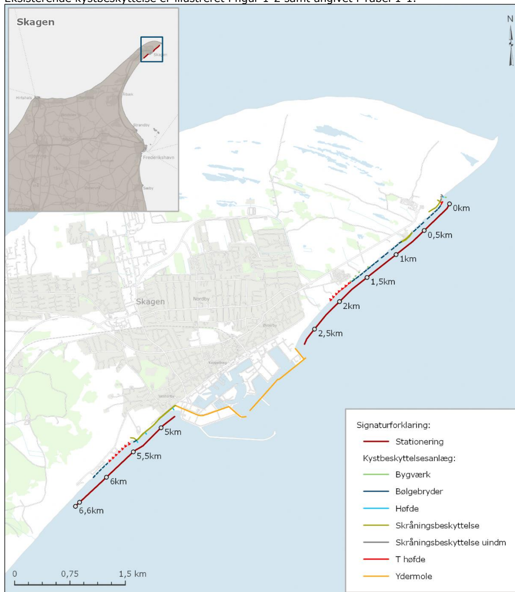
Figur 1-2. Beliggenhed af eksisterende kystbeskyttelse langs kyststrækningen ved Skagen. 2
