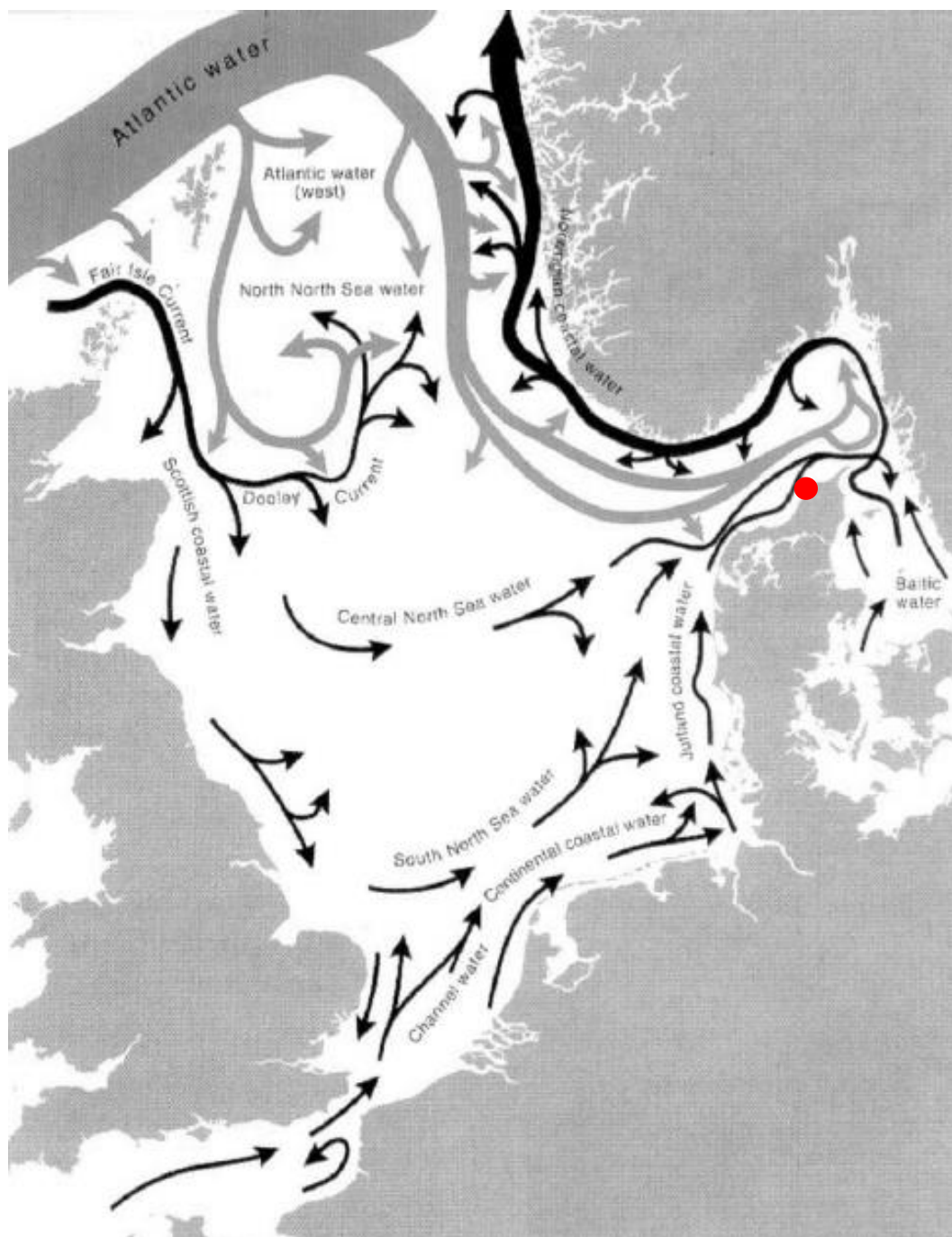
Figur 1-9. Skematisk gengivelse af netto-cirkulationen i Nordsøen, Skagerrak, samt Kattegat. Mørke pile viser strømninger i overfladen og de lyse pile viser dybereliggende strømme. Bredden på pilene indikerer styrken 15 . Rød cirkel markerer Lønstrup.
