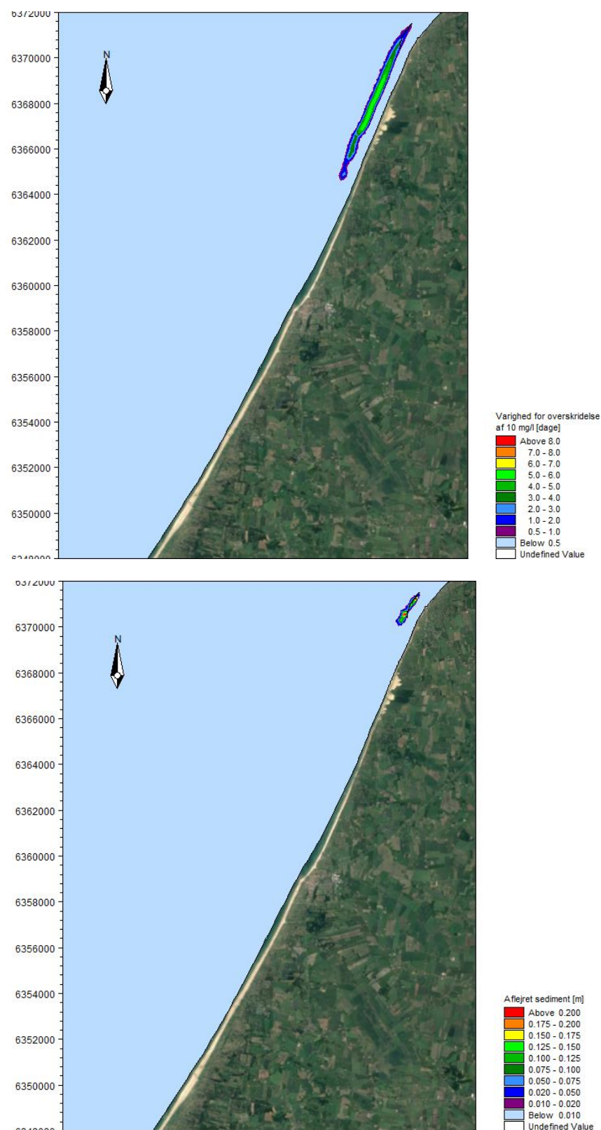
Figur 2-33. Scenarie med kystnær fodring via klapning med tre skibe for det hydrodynamiske scenarie med sydgående strøm. Figuren viser varighed for overskridelse af en sedimentkoncentration på 10 mg/l (øverst) og aflejringsstykkelse (nederst). 59
