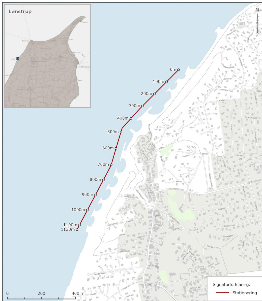
Figur 1-1. Kyststrækningen ved Lønstrup med målsætning om ingen kysttilbagerykning og hvor der udføres sandfodring.
