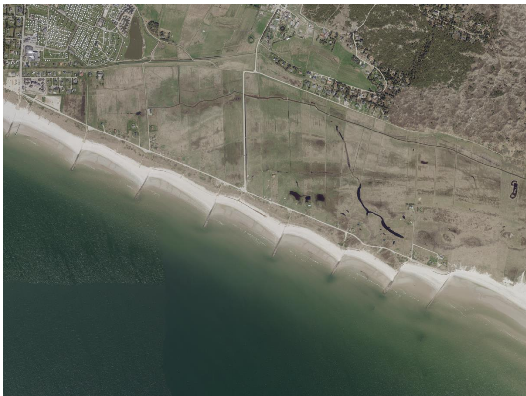
Figur 8-17. Læsideerosion og luvsideaflejring langs høfder ved Blåvand.
