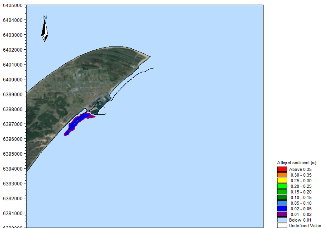
Figur 8-40. Aflejringsstykkelse ved kystnær fodring nord for Skagen Havn via rainbowing med to skibe for det hydrodynamiske scenarie med nordgående strøm. Den sorte linje parallel med kystlinjen markerer seks meter dybdekurven.
