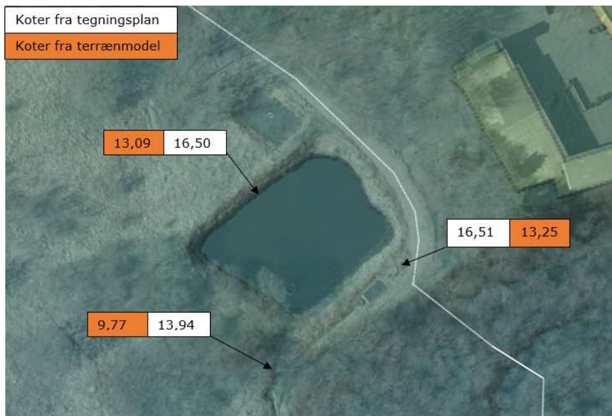
Figur 2.3: Koterne fra tegningsmateriale i D.N.N sammenlignet med koterne i terrænmodellen DVR 90. Omkring Holstebro skal de to referencer afvige med 9 cm, men der er en afvigelse på 3-4 m.
