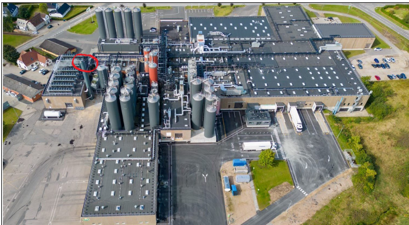
Figur 1 Placering af afkast fra kedelanlæggene. Rød ring.
