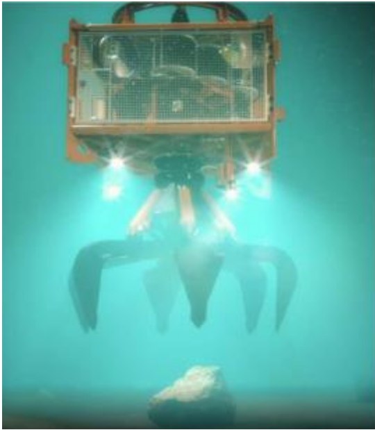
Figur 3-3. Utrustning för att avlägsna hinder som stenblock.
