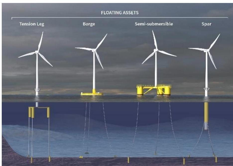
Figur 4:3. Utformningsalternativ för flytande fundament. Illustration av Acteon.
