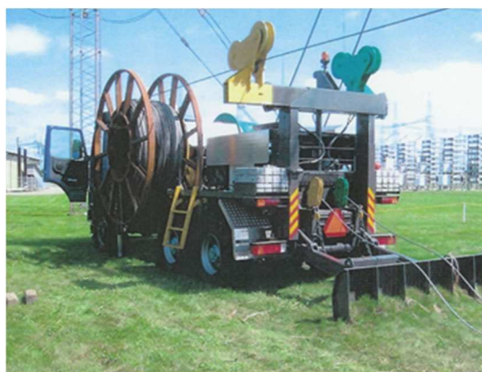
Trådtrækningsmaskine til trækning og oprulning af tråd.
