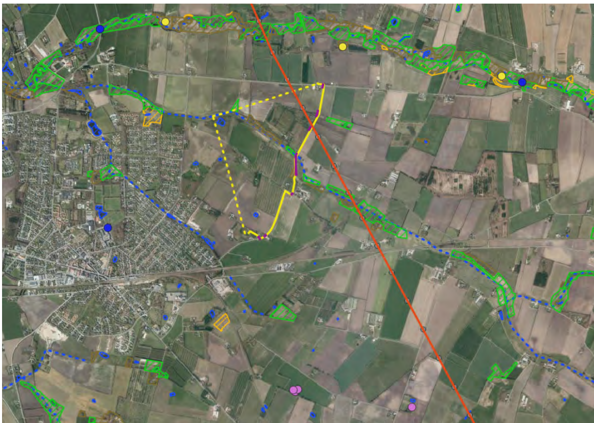
Kort 1. Kort over lokalitet ved Bramming nord. Den røde linje markerer den nye 400 kV luftledning med mastplaceringer som røde prikker. Den gule stiplede linje markerer den eksisterende 60 kV luftledning der skal kabellægges. Den gule linje viser den nye kabelføringen for 60 kV ledningen med en lilla markering der hvor kablet underbores. §3-område vises som skraverede felter. De gule prikker er fund af spidssnudet frø, mens de lilla viser fund af løgfrø.
