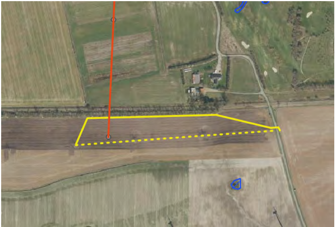
Kort 4. Kort over lokaalitet ved Tidsholm. Den røde linje markerer den nye 400 kV luftledning med masteplaceringer som røde prikker. Den gule stiplede linje markerer den eksisterende 60 kV luftledning der skal kabellægges. Den gule linje viser den nye kabelføringen for 60 kV ledningen.
