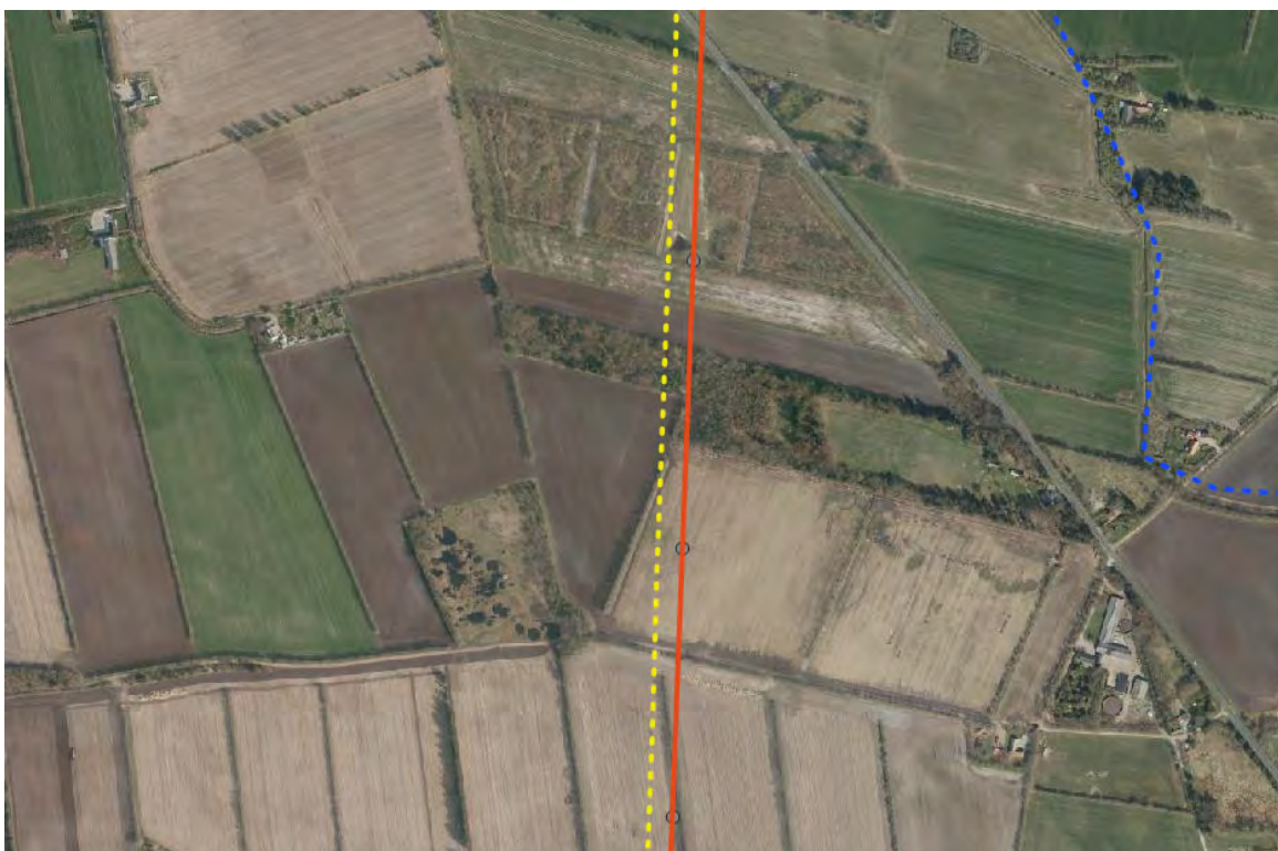
Kort 6. Kort over Lokaliteten ved Seem mark. Den røde linje markerer den nye 400 kV luftledning med masteplaceringer som røde prikker. Den gule stiplede linje markerer den eksisterende 150 kV luftledning der nedtages.
