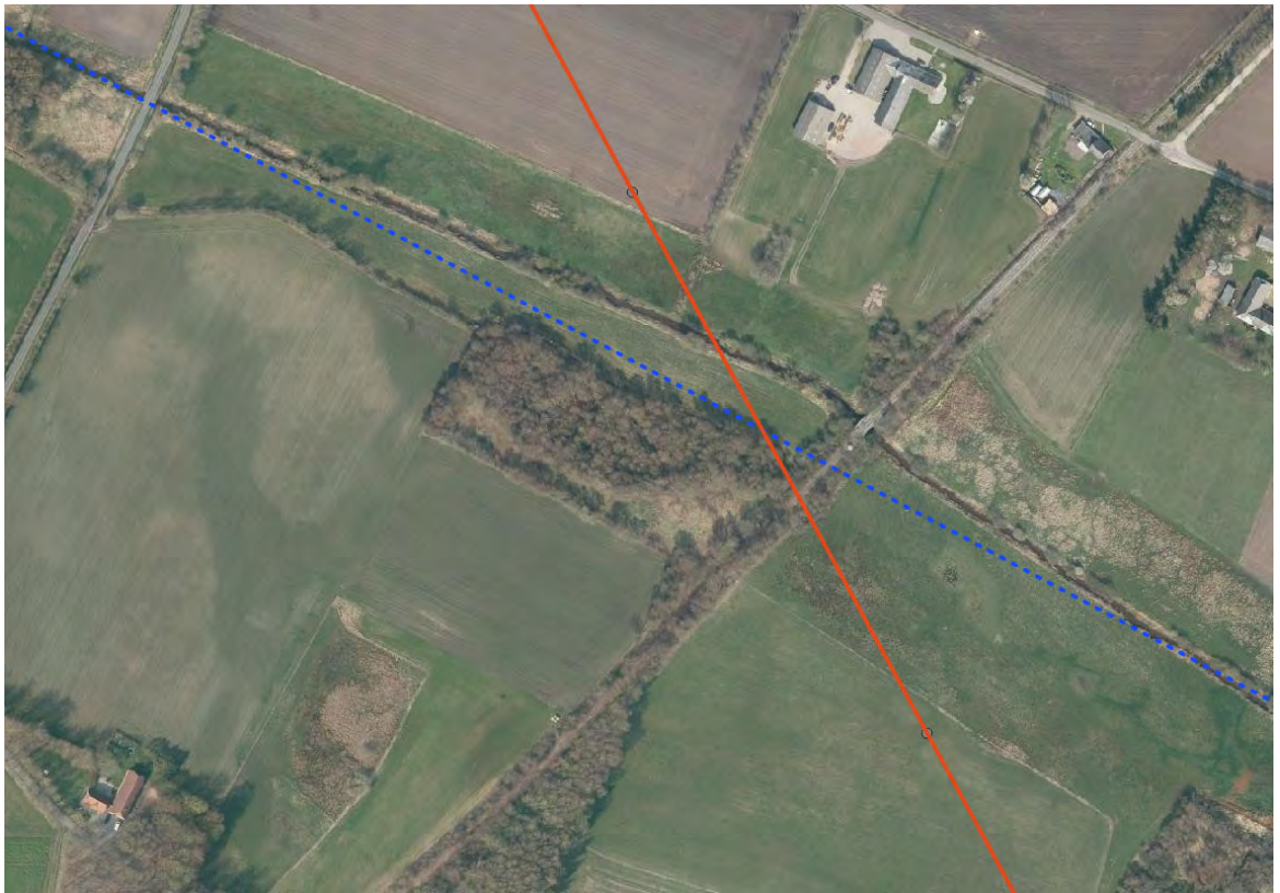
Kort 5. Kort over lokaliteten Skov ved Ilsted Å. Den røde linje markerer den nye 400 kV luftledning med mastplaceringer som brune prikker. Den blå stiplede linje markerer det beskyttede vandløb.
