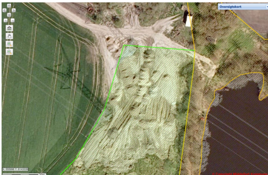
Figur 7-3 Luftfoto fra 2008 som viser, at hele området hvor mast 95 står og hvor arbejdsarealet placeres har fået tilført jord.
