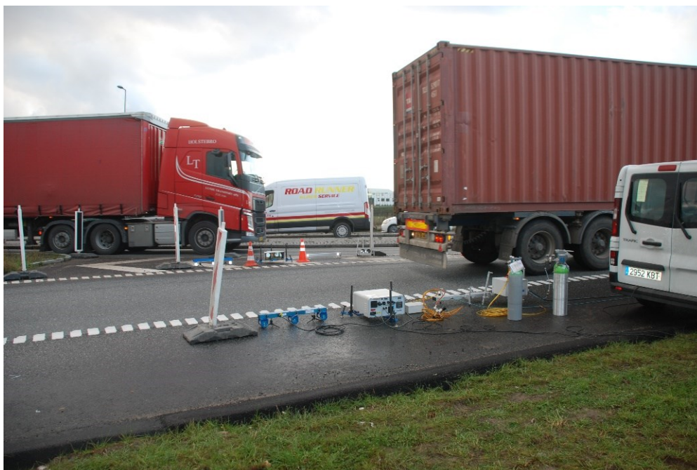
FIGUR 1. Udledning af nitrogenmonooxid er lige netop blevet målt på lastvognen med den røde container. Måleudstyret ses umiddelbart til venstre for den hvide teknikervarevogn
