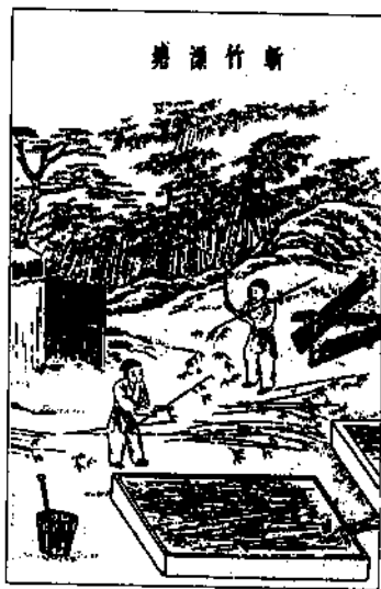
Gammel kinesisk tegning, der viser fremstillingen af papir fra bambus.
