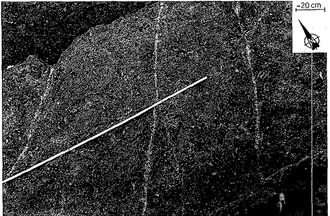
Fig. 8 Farvezoneringen omkring sprækkerne på en horisontal flade i 2 m's dybde, profil K. Bemærk den rustrøde bræmme omkring den grå sprækkezone. Endvidere viser billedet sprækkernes parallelitet og deres store horisontale udstrækning.
