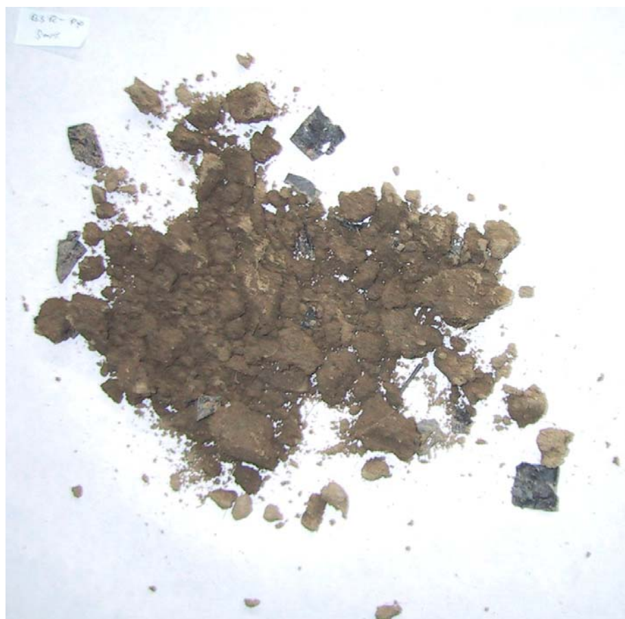
Billede 10 Resultat af nedbrydning i jord for pose nr. 6 (Nordexport/biodegradable starch resin, Kina, sort)
