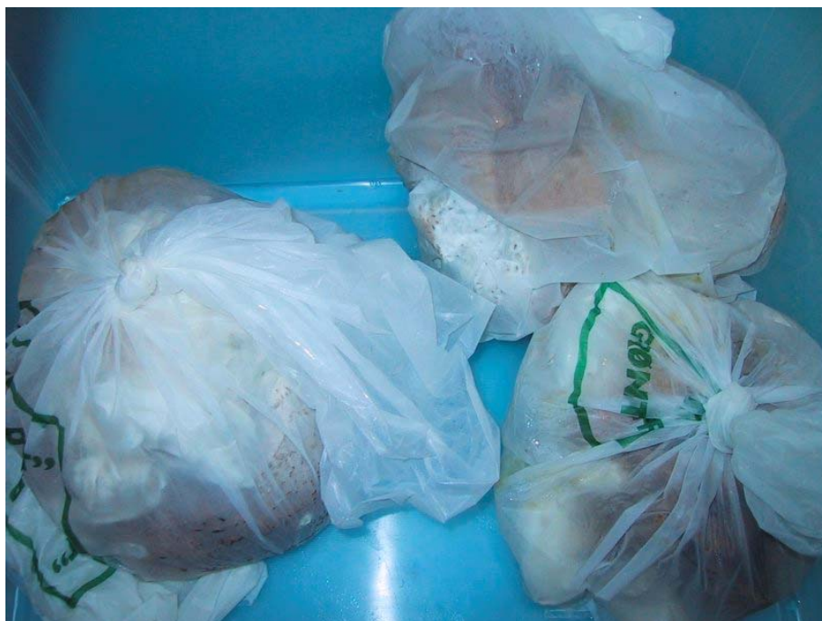
Billede 19 Sækko/Mater-Bi, hvid, 90°C efter 14 dage i varmeskab ved 30°C
