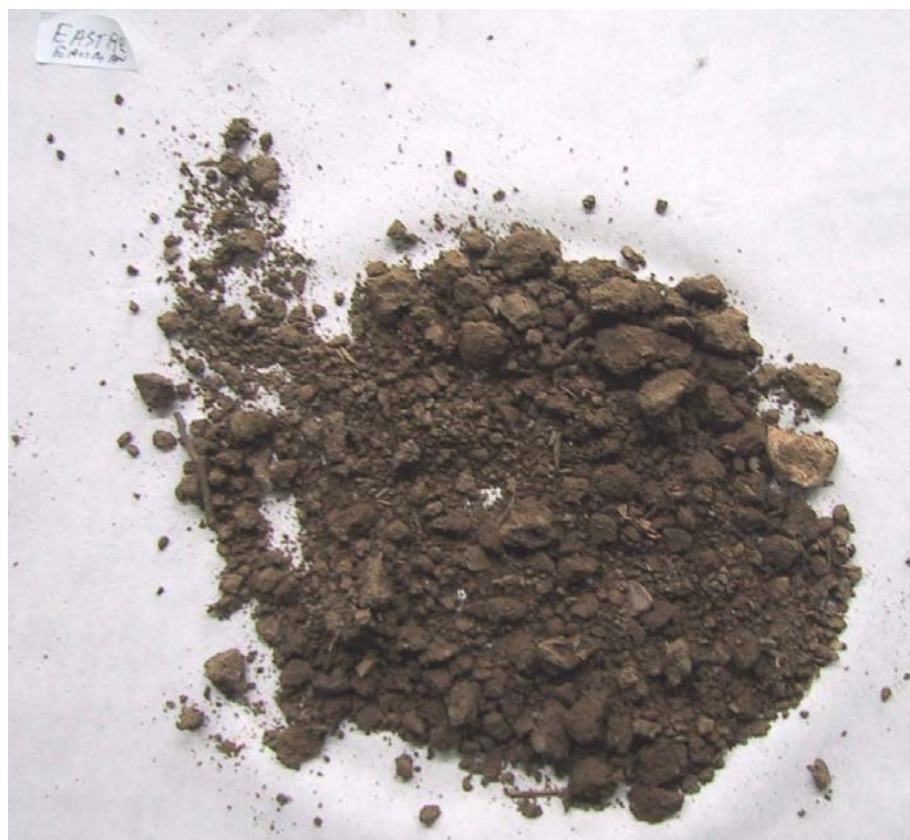
Billede 11 Resultat af nedbrydning i jord for pose nr. 8 (Eastman Chemical/Eastar)
