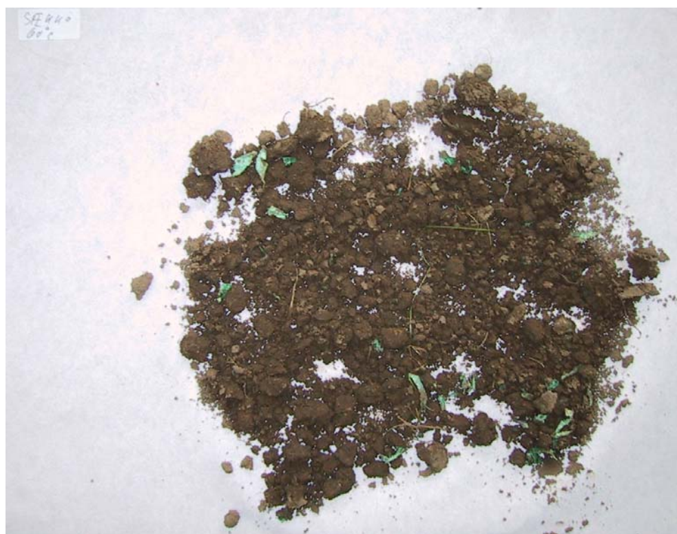
Billede 7 Resultat af nedbrydning i jord for pose nr. 2 (Sækko/Mater-Bi, 60°C)
