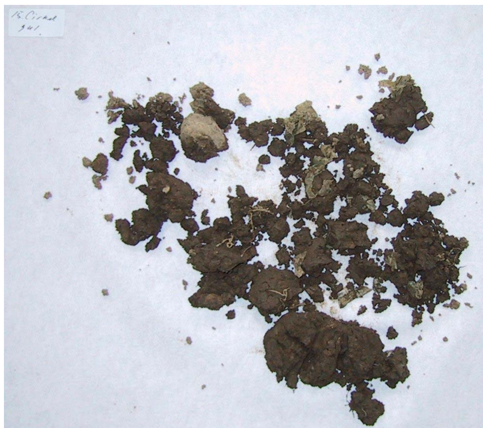
Billede 6 Resultat af nedbrydning i jord for pose nr. 1 (Trioplast/Biotec)
