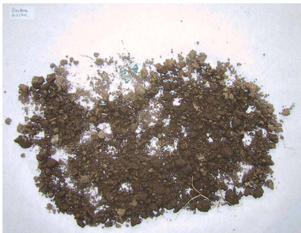
Billede 9 Resultat af nedbrydning i jord for pose nr. 4 (Wenterra Biosack)
