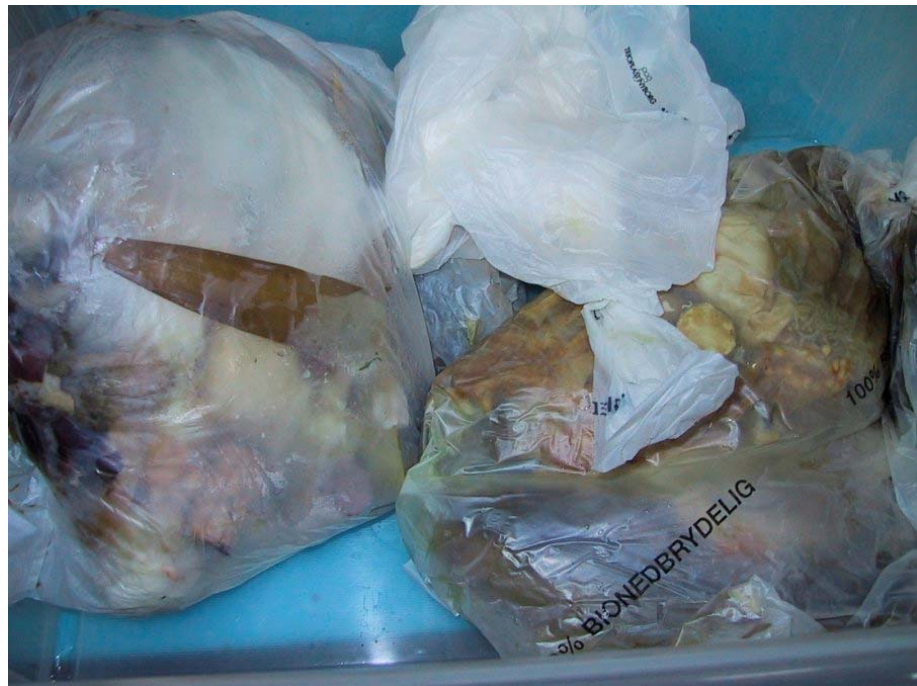
Billede 18 Trioplast/Biotec efter 14 dage i varmeskab ved 30°C
