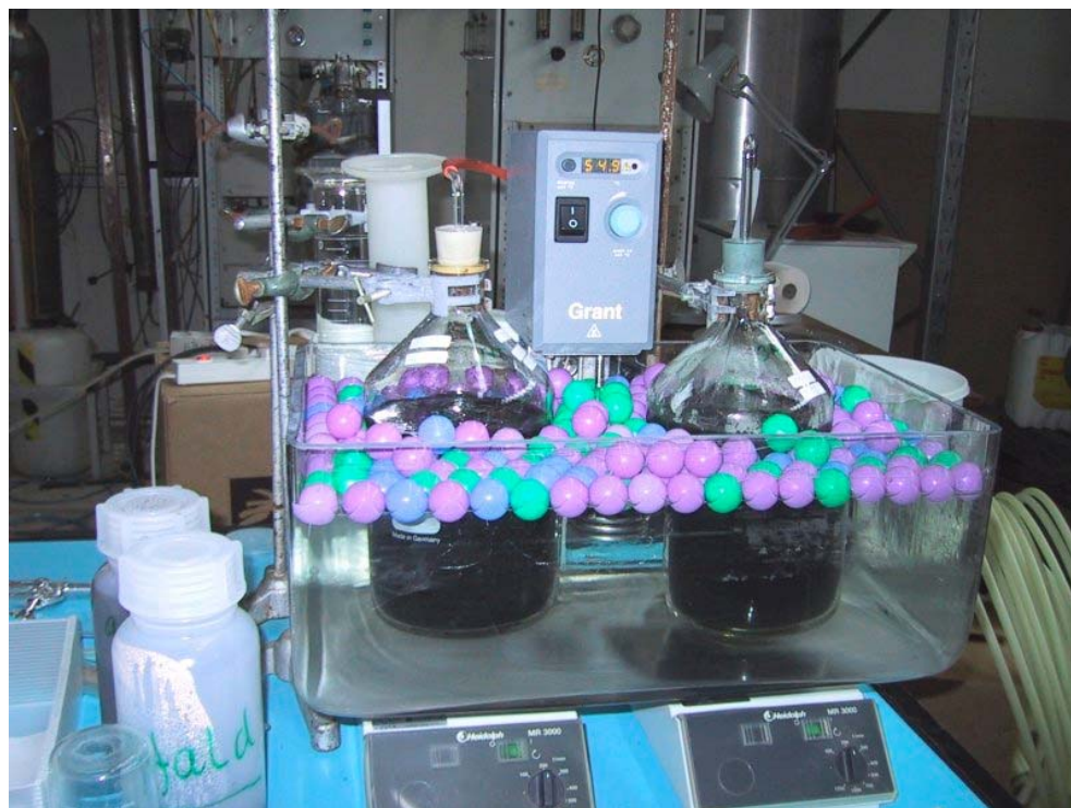
Billede 1 Laboratorieopstilling til bioforgasning af bionedbrydelige plastposer
