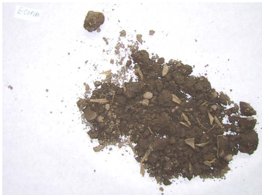
Billede 12 Resultat af nedbrydning i jord for pose nr. 9 (Rosenlew/Ecoflex)
