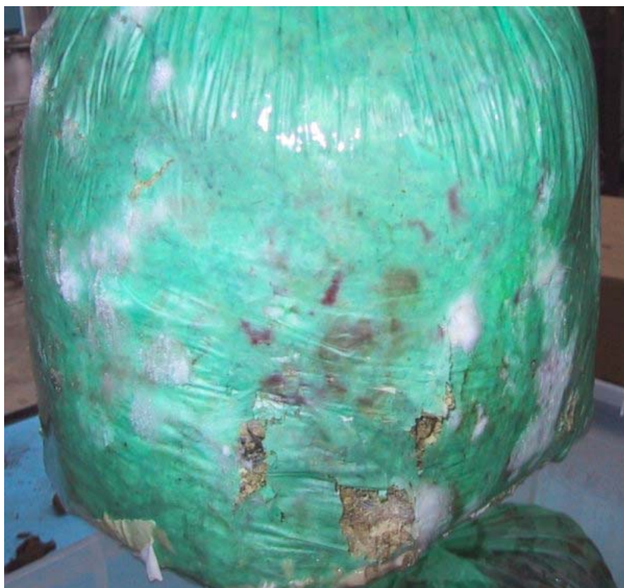
Billede 20 Sækko/Mater-Bi, grøn, 60°C efter 14 dage i varmeskab ved 30°C
