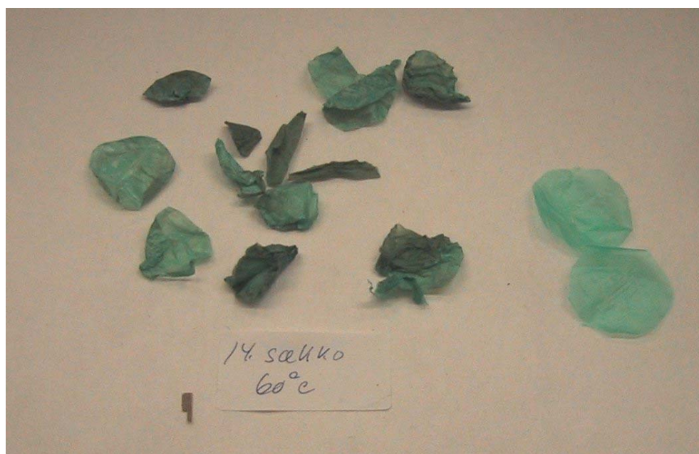
Billede 3 Strimler af poser fra Sætko/Mater-Bi 60°C før og efter bioforgasning i laboratoriereaktor
