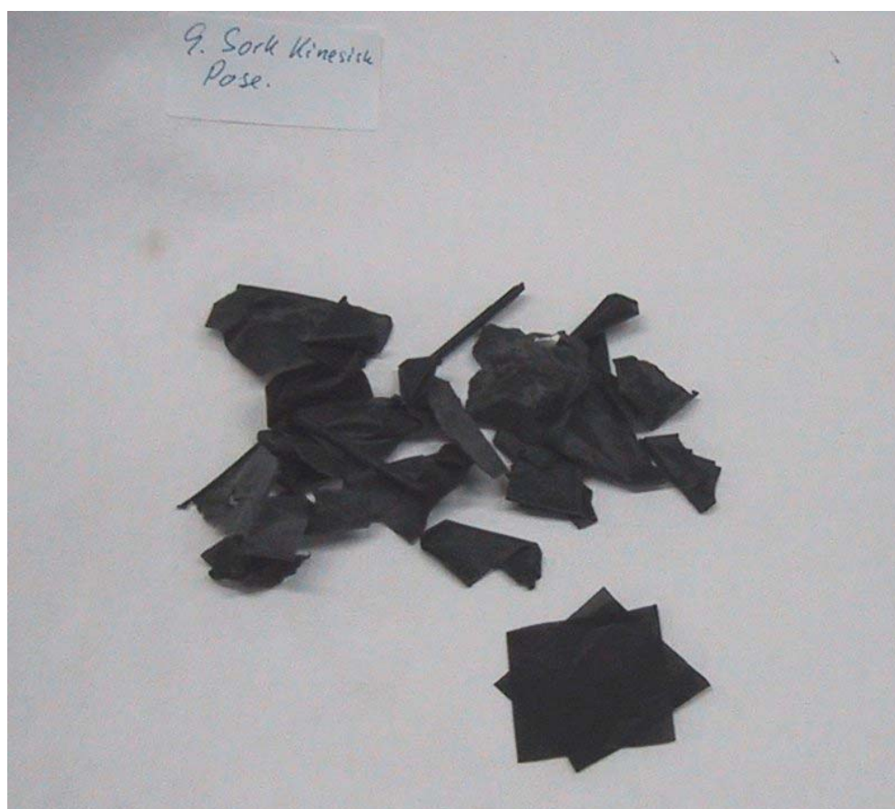
Billede 5 Strimler af poser fra Nordexport/Kina før og efter bioforgasning i laboratoriereaktor
