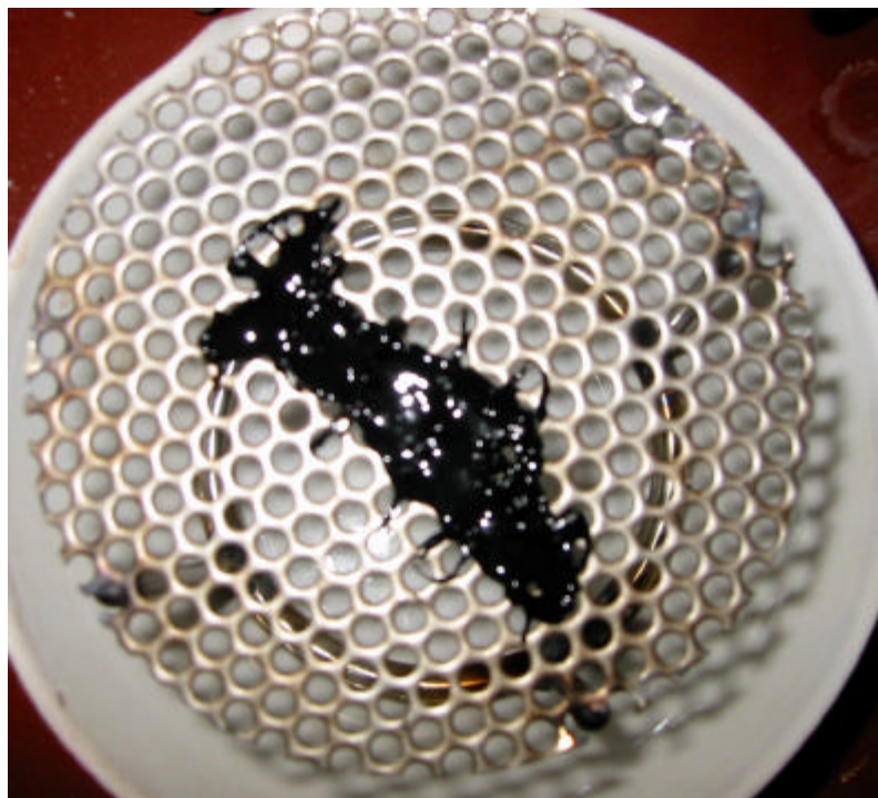
Figur 11 Smeltning af folie
