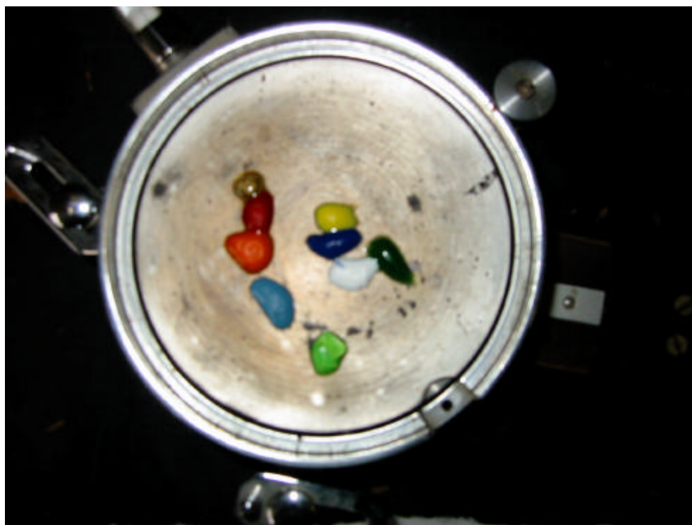
Figur 31 PP-flager smeltet ved 193 °C
