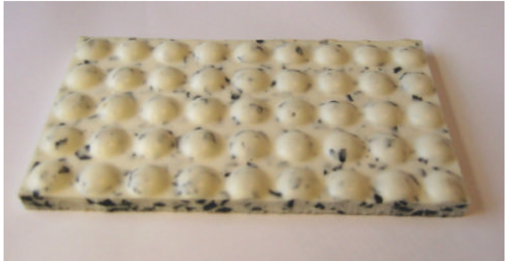
Figur 41 Produceret testemne med granuleret PUR uden tilsat farve
