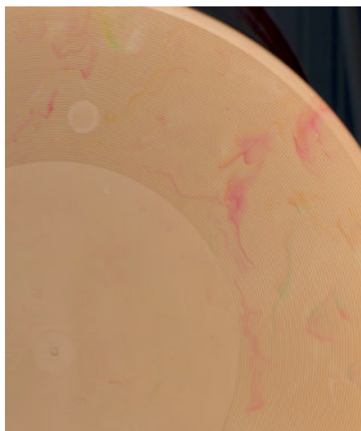
Figur 18 Spand produceret af Polypropylenproduktionsaffald
