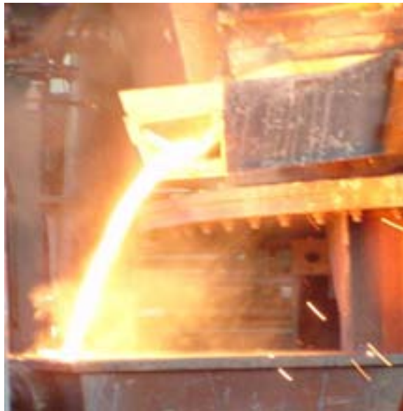
Fig. 5.3: Taping af skaktovnen
