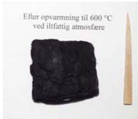
Fig. 5.4: Briket opvarmet til 600 °C
