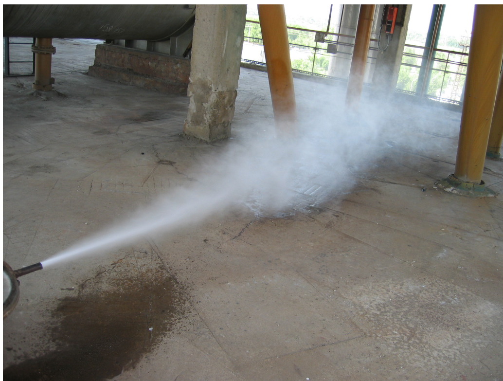
Figur A.15 En jetudslip af gas, der viser den koniske form.
