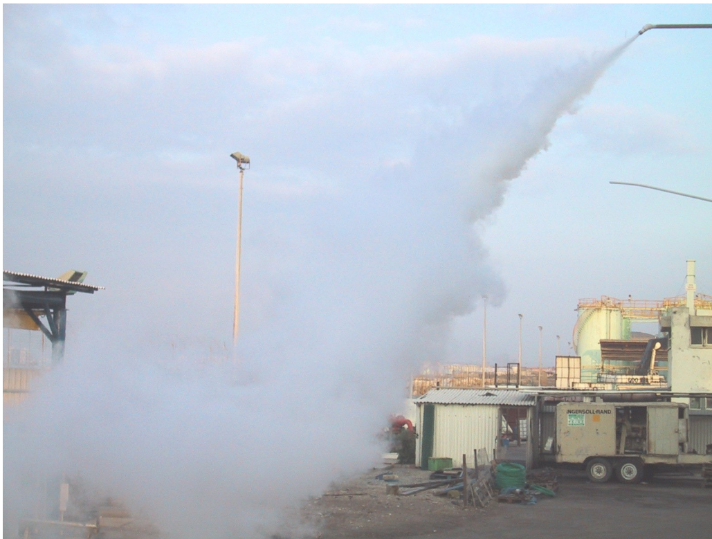
Figur 3.2 En jetudslip af gas under tryk (propylen)
