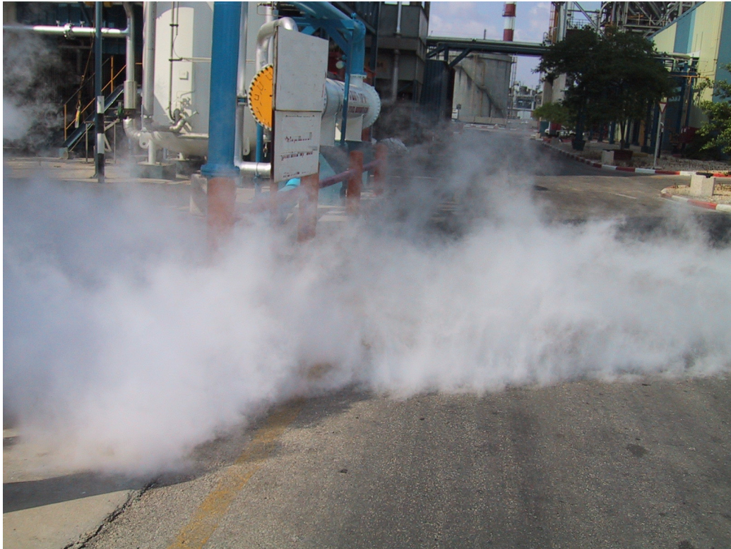
Figur 3.4 Spredning af tung gas i industriområde med meget turbulens (nitrogen).
