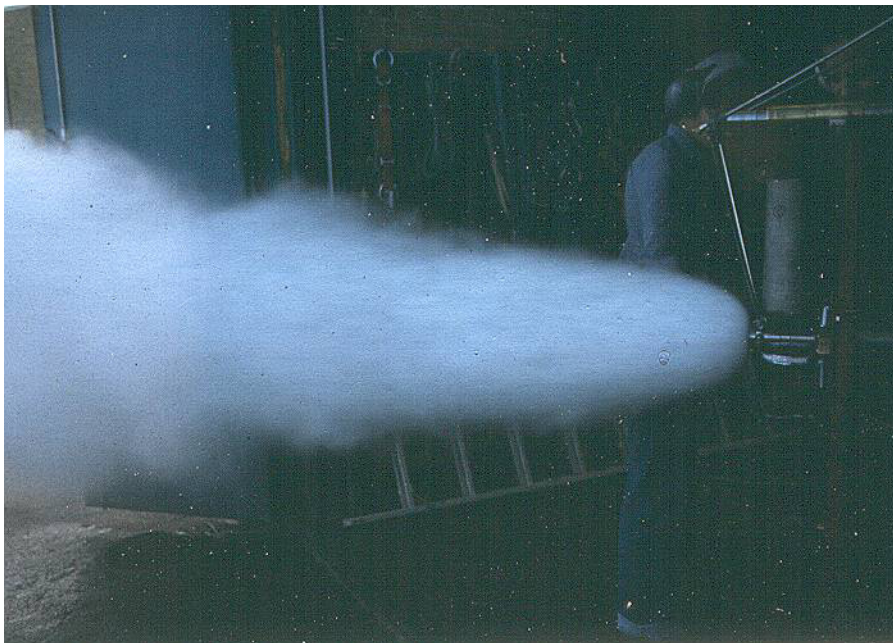
Figur 3.3 Udslip af en tofase jet (forsøg, ved anvendelse af mindre farlig stof, dvs. vand over kogepunktet)
