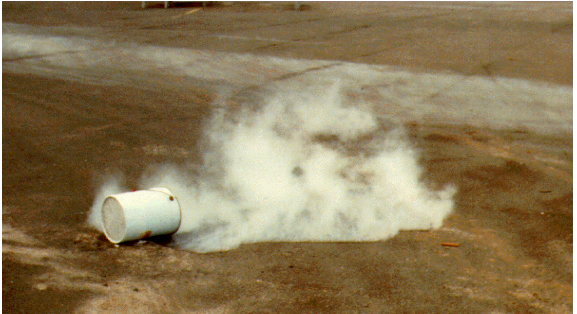
Figur 3.6 Udslip og fordampning af et kryogen væske (ammoniak, bemærk at oxygen og nitrogen spredt på den samme måde))
