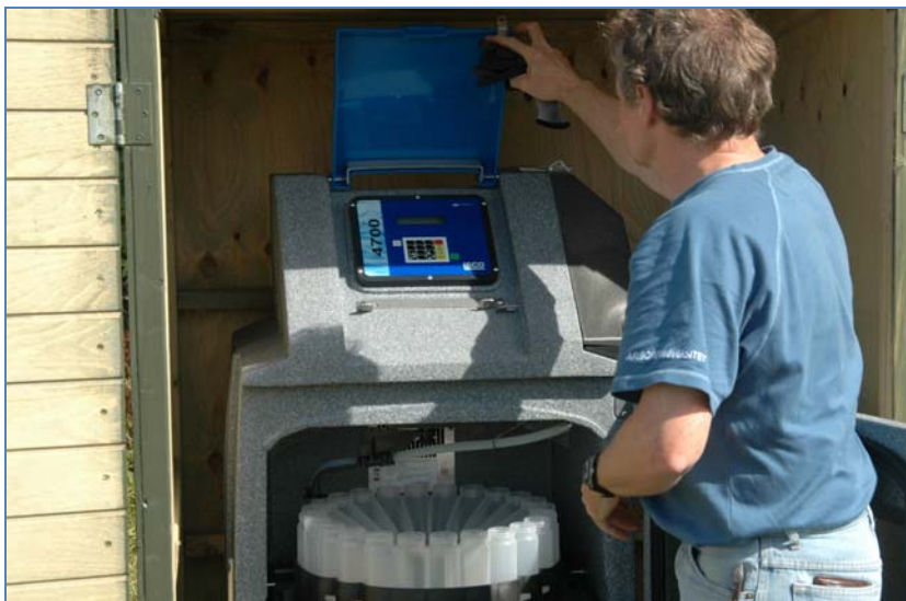
Billede 12 Prøvetager med køling i skur ved indløb
