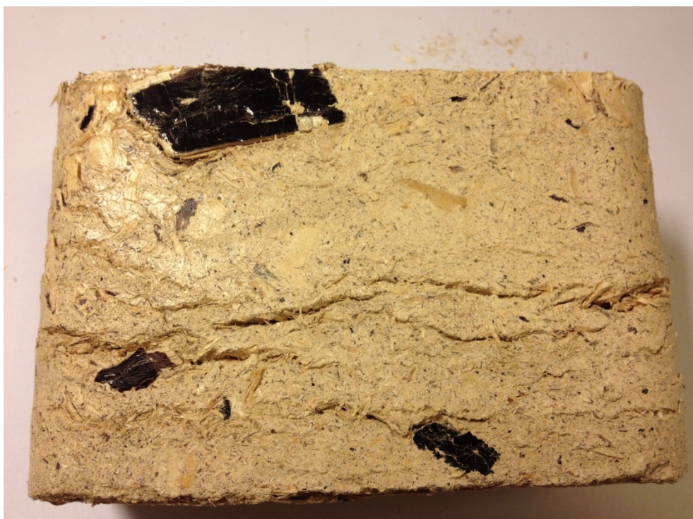
FIGUR 2 TRÆBRIKET FREMSTILLET AF AFFALDSTRÆ MED TYDELIGE LIMFLADER
