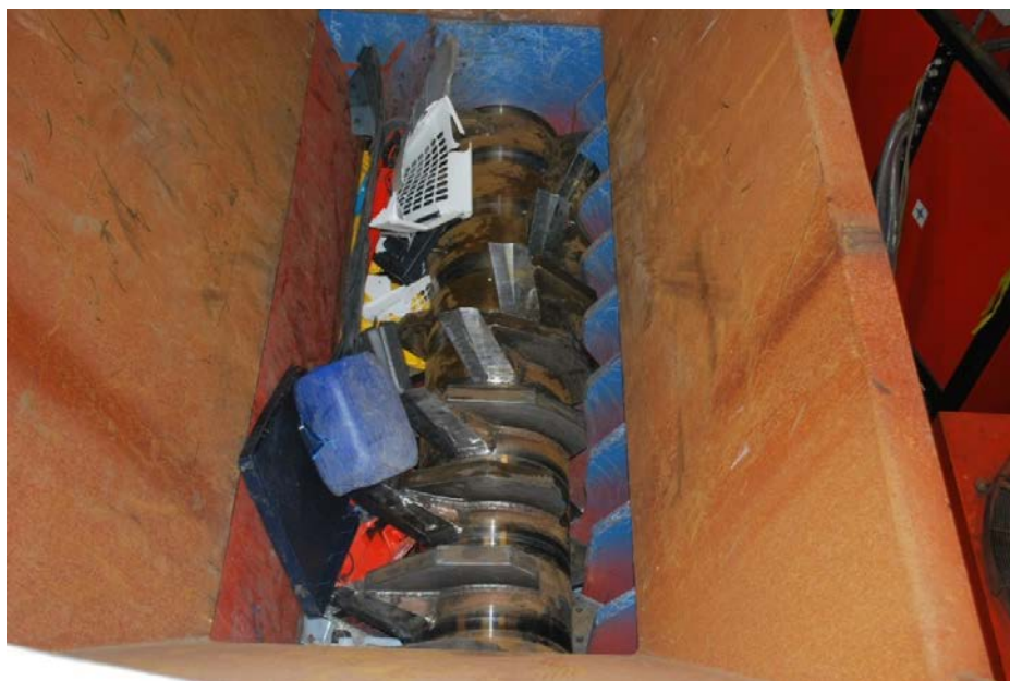
FIGUR 12: FORSHREDDER FRA DET DANSKE FIRMA ELDAN RECYCLING UNDER NEDDELING AF Blandet PLAST FRA GENBRUGSPLODSE
