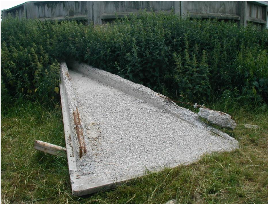
Figur 7.17 Beholderlæg (undersiden) fra gødningsbeholdere. Det er kraftigt eroderet som følge af manglende ventilation og en beholdervæske, der tilsættes industriaffald.
