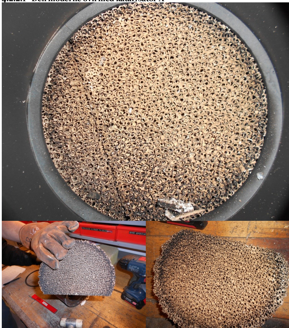
FIGUR 31: KATALYSATOR A EFTER FYRING I DEN MODERNE BRÆNDEOVN. DER SES EN MINDRE SOD DANNELSE PÅ ELEMENTET
