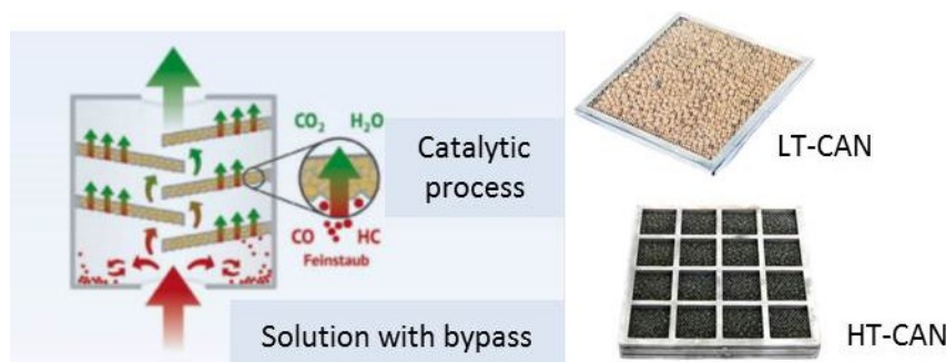
FIGUR 4: CHIMCAT®RETRO DRIFTSPRINCIPPER OG PATRONER MED FORSKELLIGE UEMBALLERET GRANULAT (CHIMCAT®RETRO, 2013)
