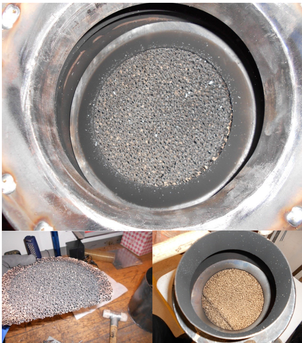
FIGUR 34: KATALYSATOR A EFTER FYRING I DEN GAMLE OVN SAMT BILLEDET NEDERST TIL HØJRE FØR FYRING
