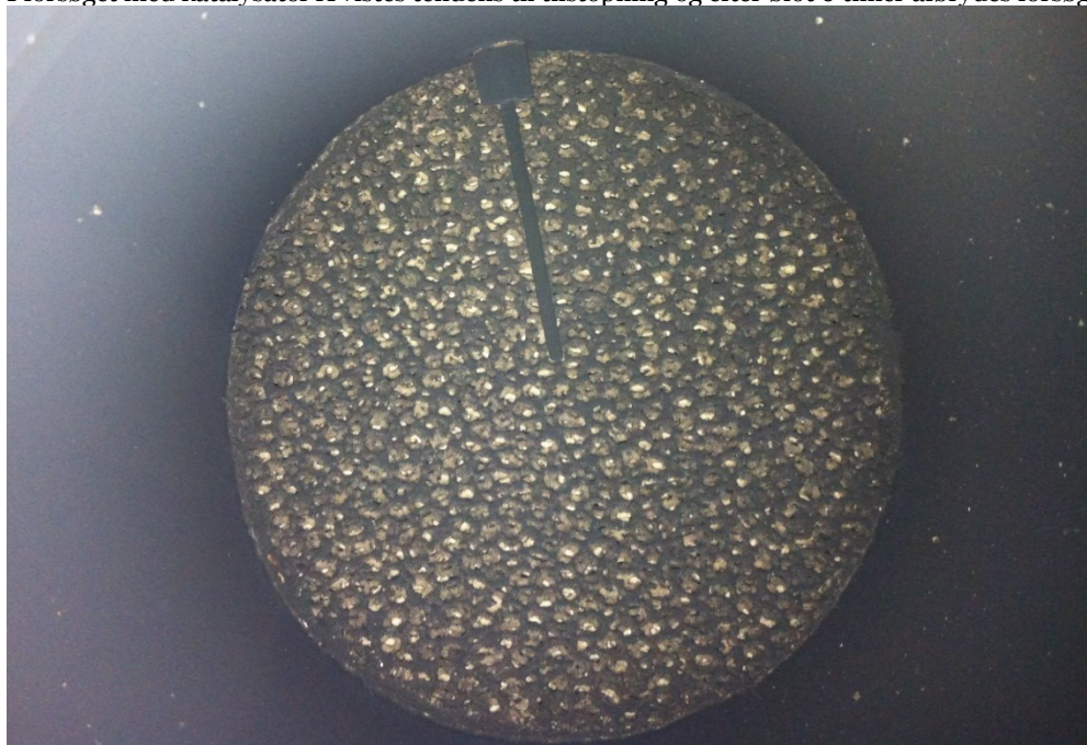
FIGUR 57 KATALYSATOR A TILSTOPPET EFTER 6 TIMERS FYRING I KEDLEN
