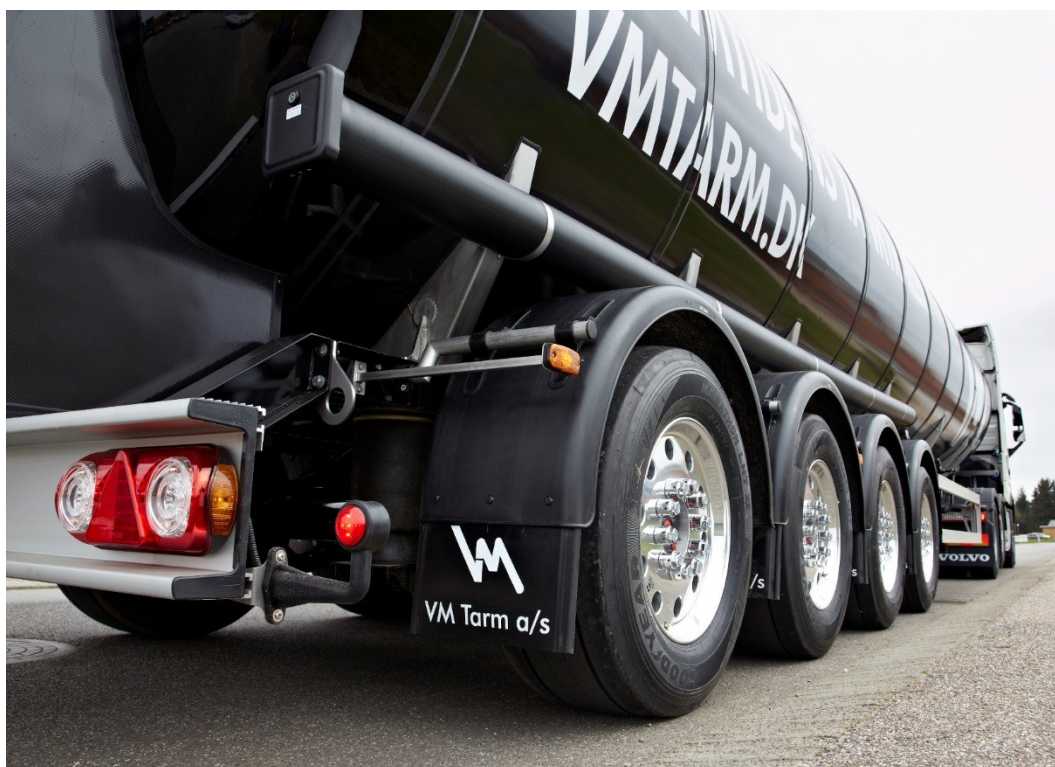
BILLEDE 59 PROTOTYPENS HØJRE SIDE. BEMÆRK UNDERVOGNSRAMME OG SKÆRMOPHÆNG.
