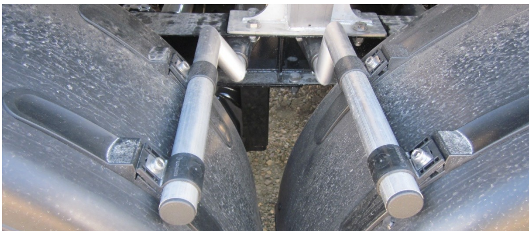
BILLEDE 49 SKÆRMHOLDERE I OPTIMERET DESIGN PÅ PROTOTYPEN.
