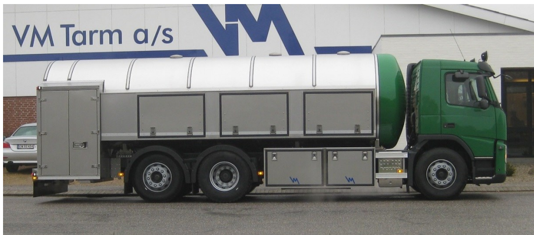
BILLEDE 4 FORVOGN MED PED TANK TIL TRANSPORT AF ØL.
