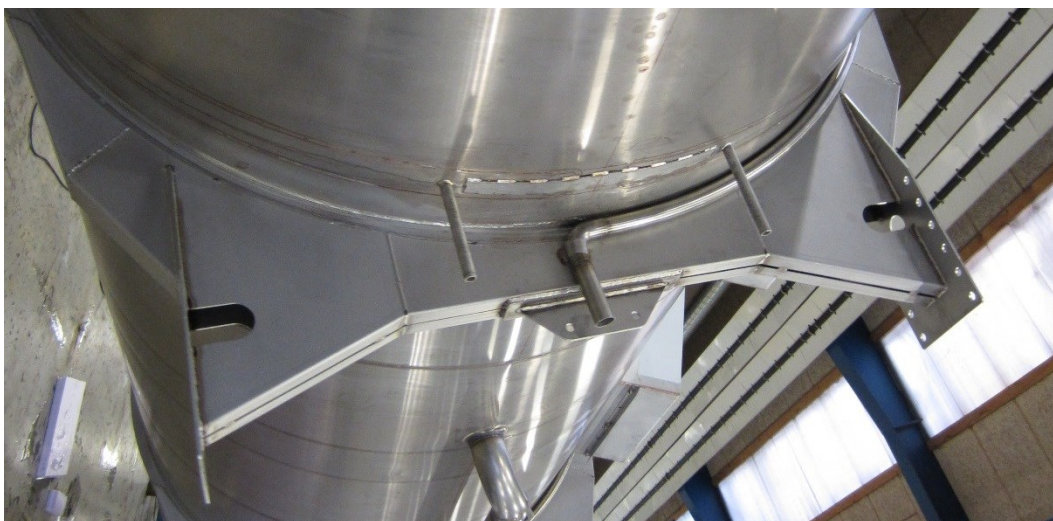
BILLEDE 34 KONSOL TIL STØTTEBEN SVEJST PÅ PROTOTYPEN.
