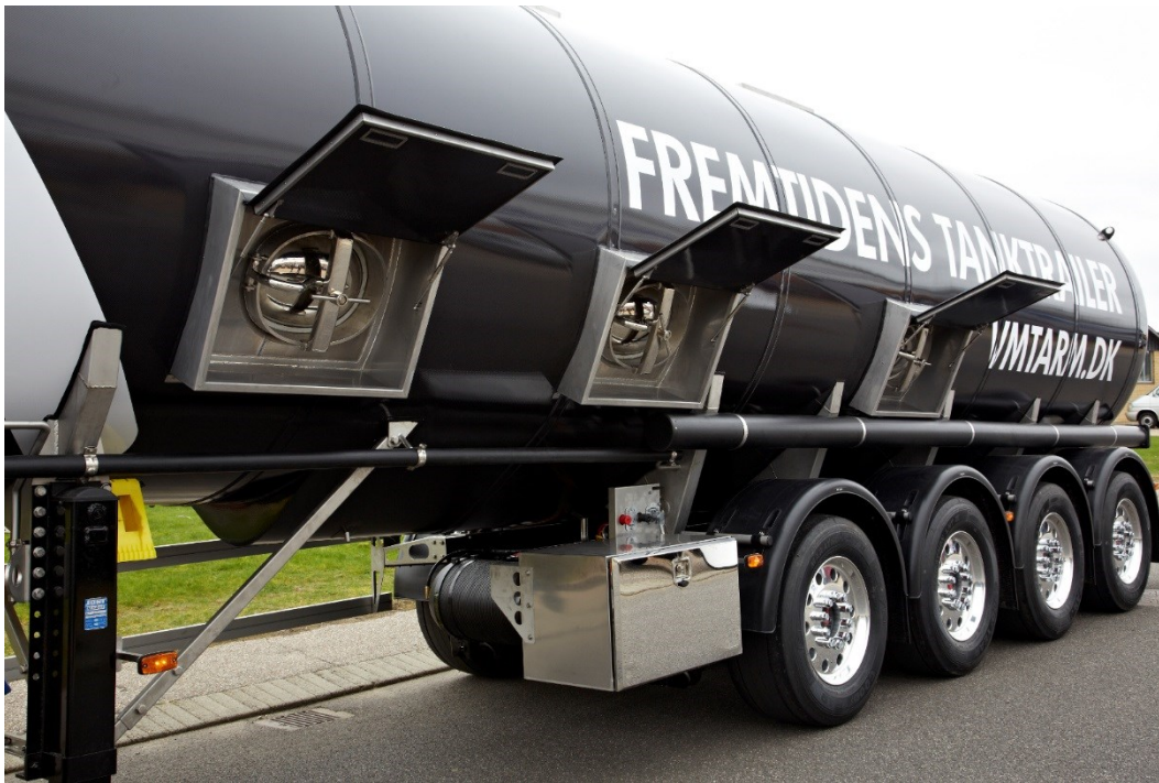
BILLEDE 57 PROTOTYPENS VENSTRE SIDE. BEMÆRK KULFIBER KAPPE, SKABE MED SIDEMANDEDÆKSLER, VARESKAB MED OPHÆNG, SLANGERØR MED OPHÆNG, DÆK I REDUCERET DIAMETER, SPECIALFÆLGE TIL REDUCERET NAVSTØRRELSE, KOMPOSITTTANK TIL TRYKLUF TIL OG LEDNINGSRØR I SORT PLAST.
