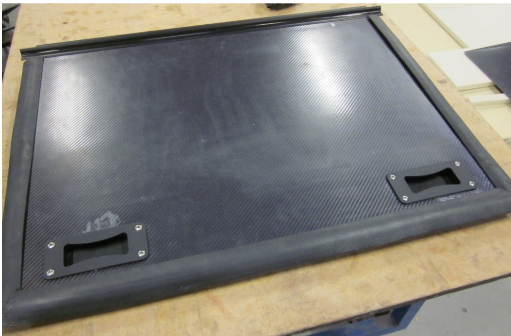
BILLEDE 41 NYT LÅGEDESIGN I KOMPOSIT UDEN BRUG AF ALUMINIUM.
