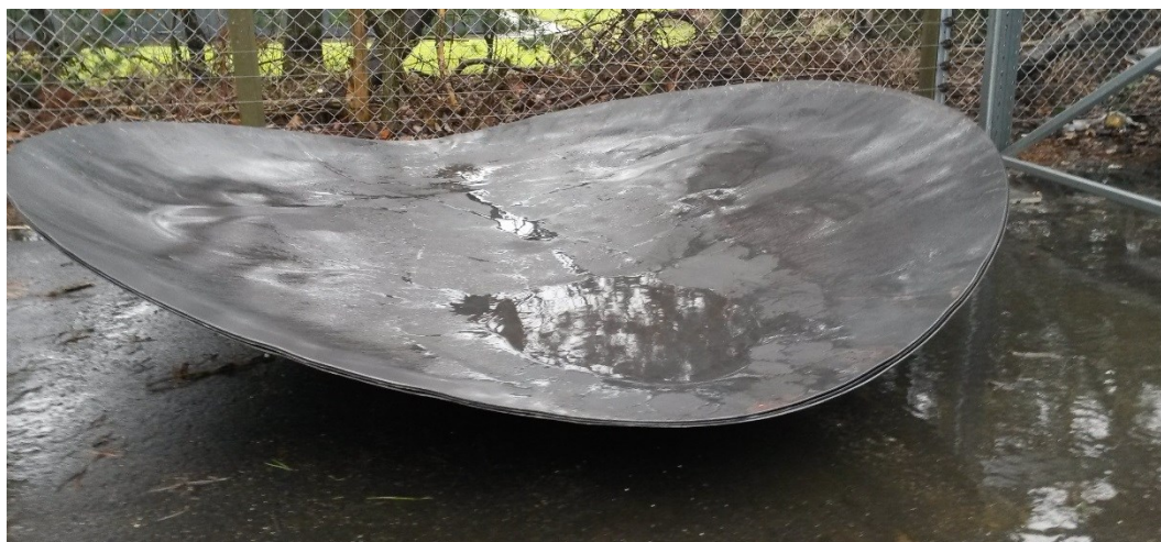
BILLEDE 55 DUPLIX PLADER EFTER FORSØG PÅ FREMSTILLING AF SKVULPEKOT. BEMÆRK DE STORE BULER MIDT PÅ PLADEN.
