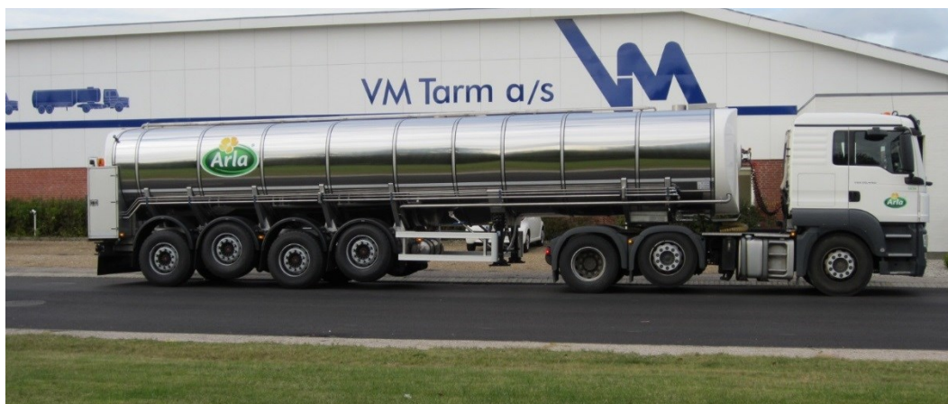
BILLEDE 5 SEMITRAILER MED TRYKLØS TANK TIL TRANSPORT AF MÆLK.
