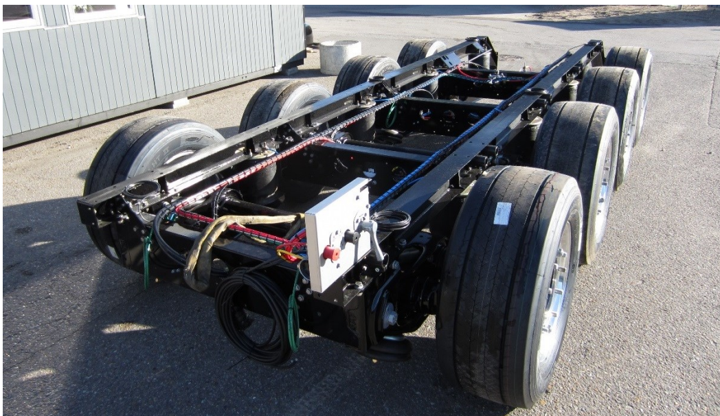
BILLEDE 14 UNDERVOGN I NYT DESIGN FÆRDIGMONTERET MED AKSLER.
