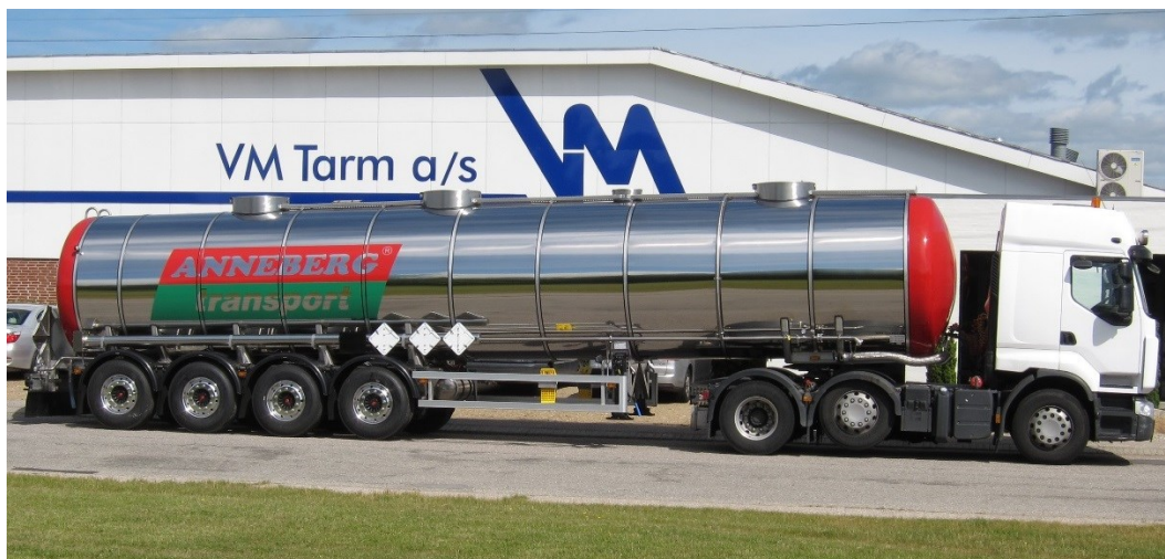
BILLEDE 3 ADR SEMITRAILER TIL TRANSPORT AF BITUMEN.
