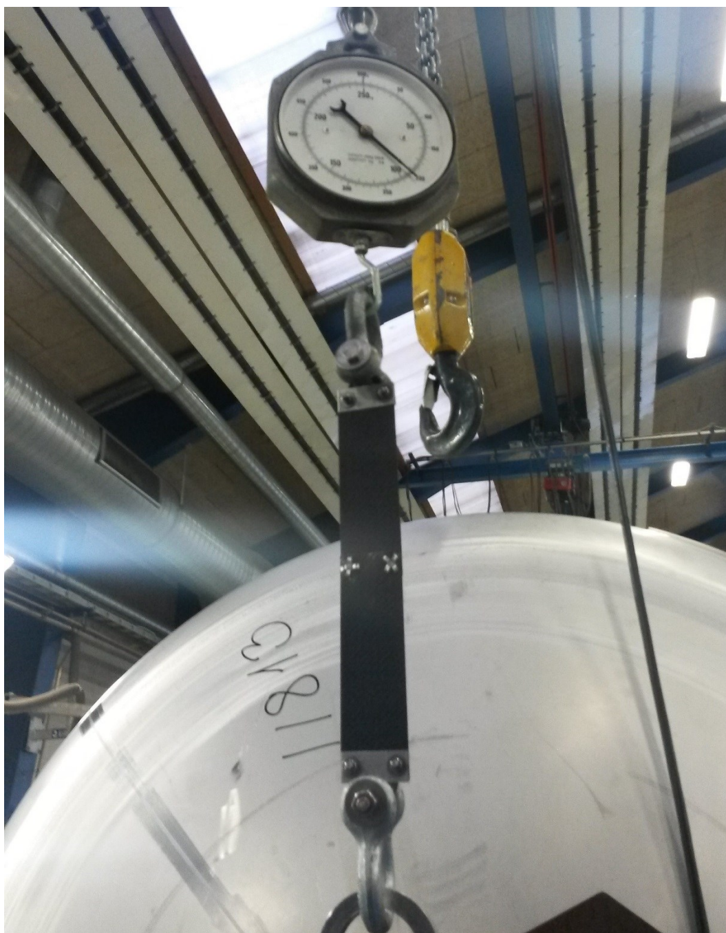
BILLEDE 39 STYRKETEST AF KAPPEBÅND I KULFIBER KOMPOSIT.
