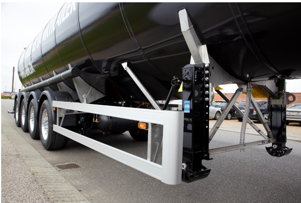
BILLEDE 58 PROTOTYPENS HØJRE SIDE. BEMÆRK ALUMINIUMS STØTTEBEN, VÆGTOPTIMERET STØTTEBENSKONSOL OG SKRÅSTIVERE FOR STØTTEBEN.
