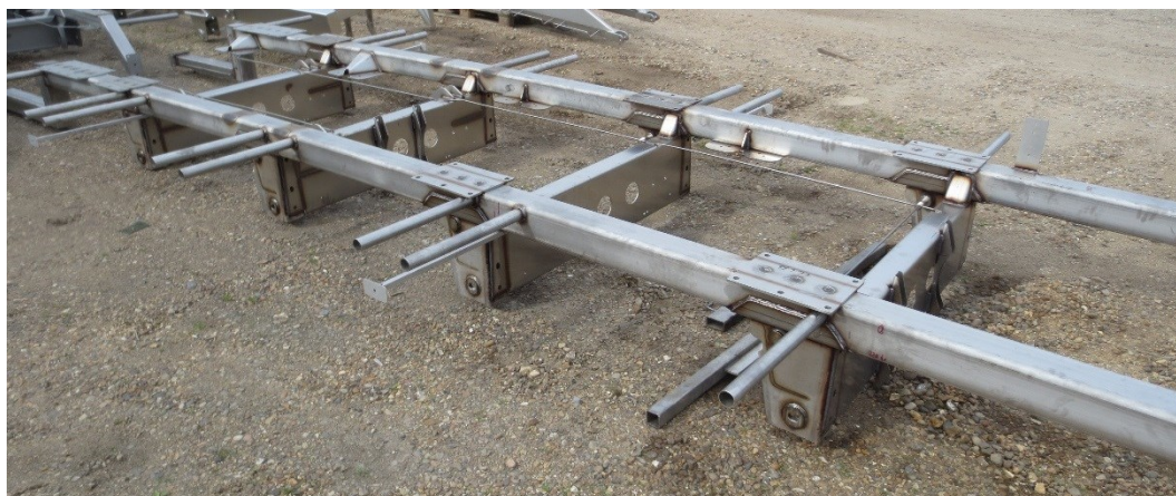
BILLEDE 6 RUSTFAST UNDERVOGN BASERET PÅ PROFILRØR.
