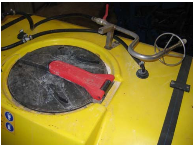
TÅGESPRØJTE MED MONTERING AF EN UDVENDIG SPULEDYSE, DER GØR DET MULIGT AF SKYLLE TOM EMBALLAGE. PÅ GRUND AF SPRØJTENS RINGE STØRRELSE KAN PÅFYLDNING AF KONCENTRERET BEKÆMPELSMIDDEL OG SKYLLEVAND SKE DIREKTE GENNEM ÅBNINGEN I SPRØJTETANKEN FOTO: NIELS ENGGAARD KLAUSEN
