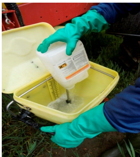
EN SPULEDYSE SIKRER EN NEM OG SIKKER SKYLNING AF TOM EMBALLAGE
