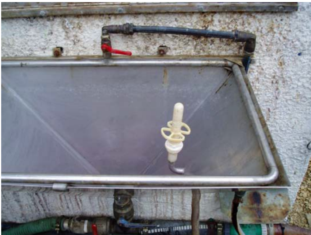
FAST MONTERET PRÆPARATFYLD, HVORFRA SPRØJTEMIDLERNE SUGES OP I SPRØJTETANKEN. ENHEDEN ER UDSKYRET MED SPULEDYSE TIL TOMME DUNKE FOTO: POUL HENNING PETERSEN
