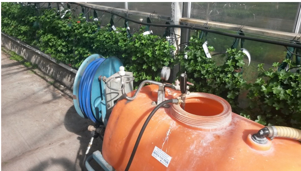
SPRØJTE MED PÅFYLDEUDSTYR OG SPULEDYSE TIL AT SKYLLE TOM EMBALLAGE. FOTO: NIELS ENGGAARD KLAUSEN
