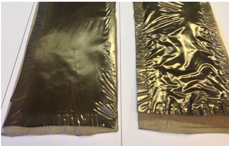
FIGUR 4.10: C (20 \mu M) OG A (20 \mu M) FOLIE EFTER TEST I WEATHER OMETER. (FORSIDEN – SIDEN DER VENDER UD MOD UV-LYSKILDEN)
