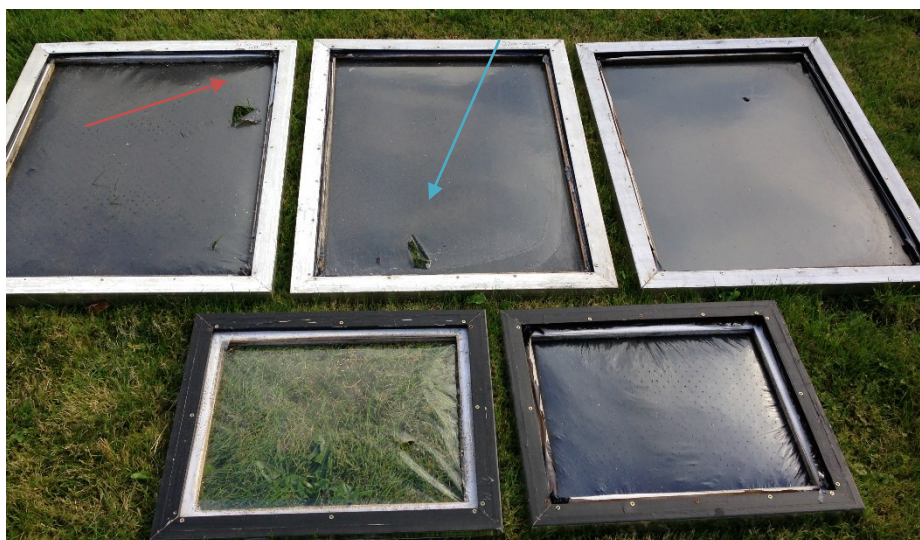
FIGUR 5.17 FOLIER PÅ GRÆS DEN 6. OKTOBER – FLÆNGE I SORT C 20 \mu M (MARKERET MED BLÅT) SAMT SORT A MED PERFORERINGER.
