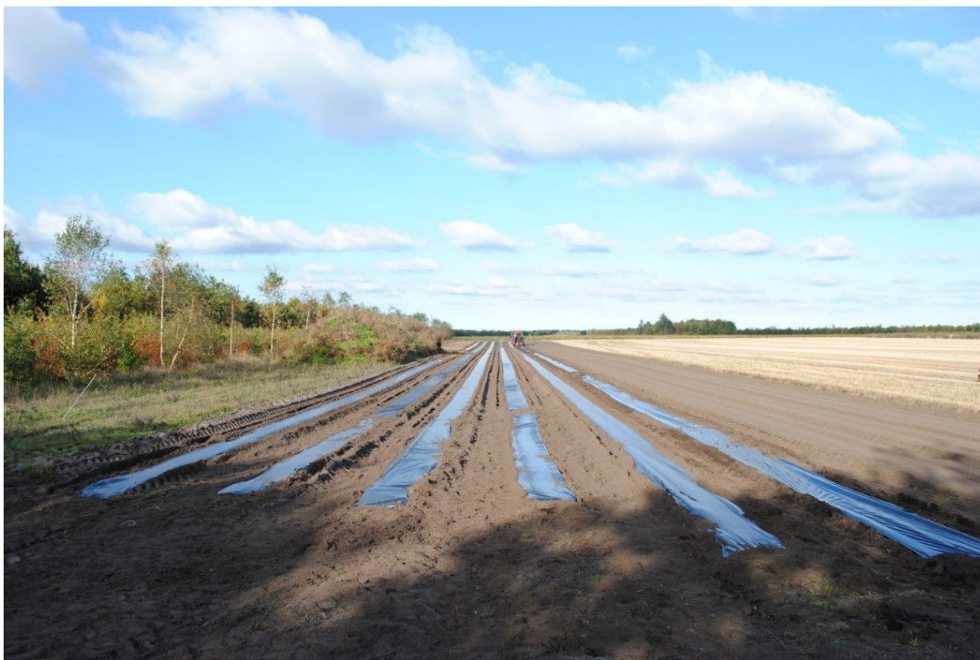
FIGUR 5.29: RÆKKER MED DE FORSKELLIGE KOMBINATIONER AF FOLIER DELS LAMINERET OG DELS SOM SINGLE TIL SAMMENLIGNING.
