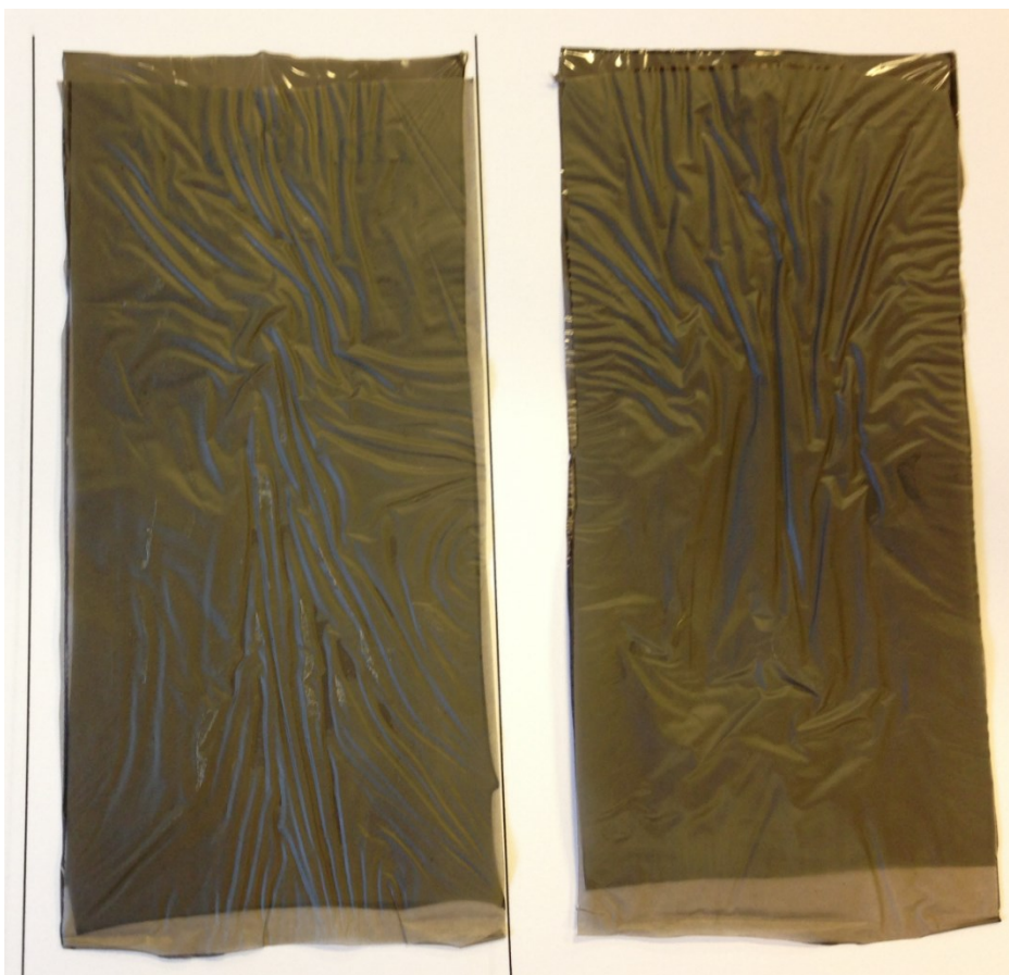
FIGUR 4.11: A (20 \mu M) OG C (20 \mu M) FOLIE EFTER TEST I WEATHER OMETER. (BAGSIDEN – SIDEN DER VENDER VÆK FRA UV-LYSKILDEN)
