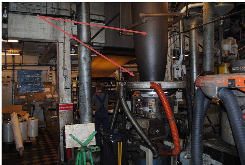
FIGUR 5.1 FOLIEBLÆSNING MED BLÆSEHOVED OG BALLON
