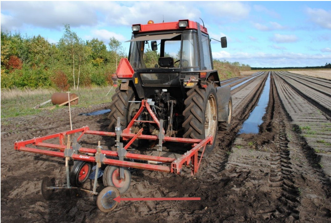
FIGUR 5.27: TALLERKENHJULENE SKULLE JUSTERES OMHYGGELIGT FOR AT FÅ EN ENSARTET DÆKNING MED JORD.
