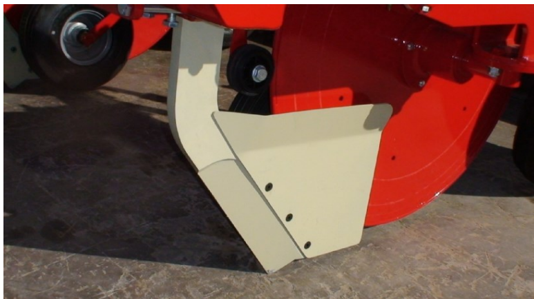
FIGUR 5.35: UDLÆGGER MED VERTIKAL NEDFÆLDELSE AF FOLIE (FOTO FRA YDING SMEDIE)
