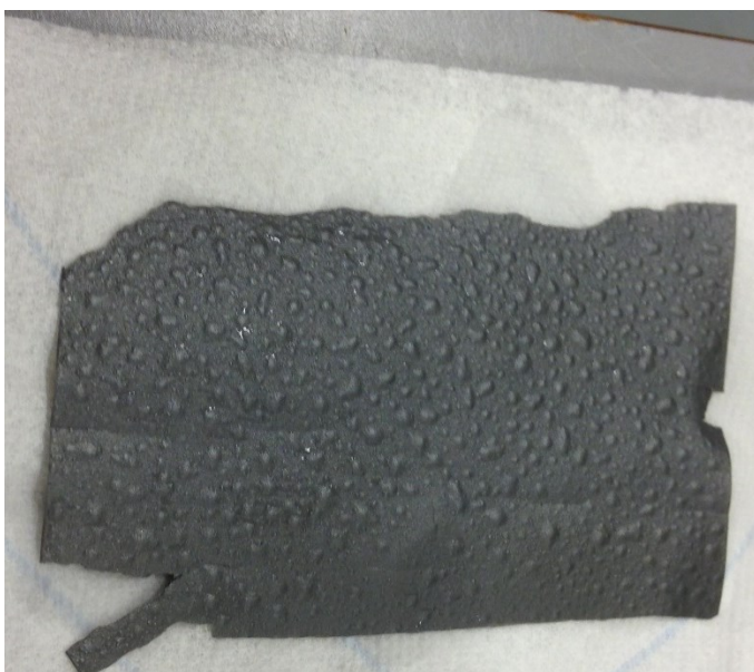
FIGUR 4.2: C MED BLÆRER PÅ OVERFLADEN – FOLIEN VAR NÆSTEN HELT ØDELAGT.
