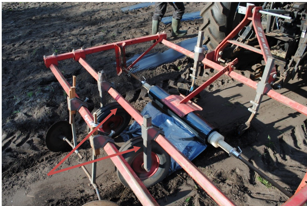
FIGUR 5.26: VED IGANGSÆTNING SKULLE FOLIEN FASTGØRES INDTIL GUMMIHJULENE FÅR FAT.
