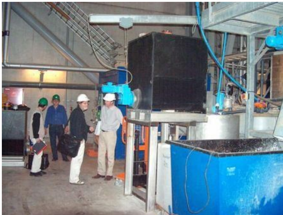
Figur 9: Beholder med stativ, transportør og motor til indføding af tørt RGA fra VF direkte i slurrtanken på HALOSEP pilotanlægget
