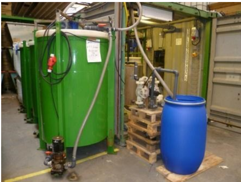
BILLEDE 7: CENTRIFUGAT BUFFERTANK (VENSTRE), RGA (SLURRY) INDFØDNING (HØJRE)
