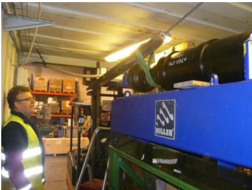
BILLEDE 9: RENGJORT ROTOR MONTERES I CENTRIFUGEN
