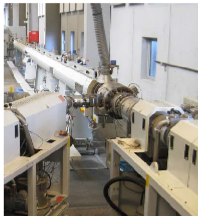
Et produktions anlæg for 3-lags rør. Der anvendes to ekstrudere (Wavin foto)
