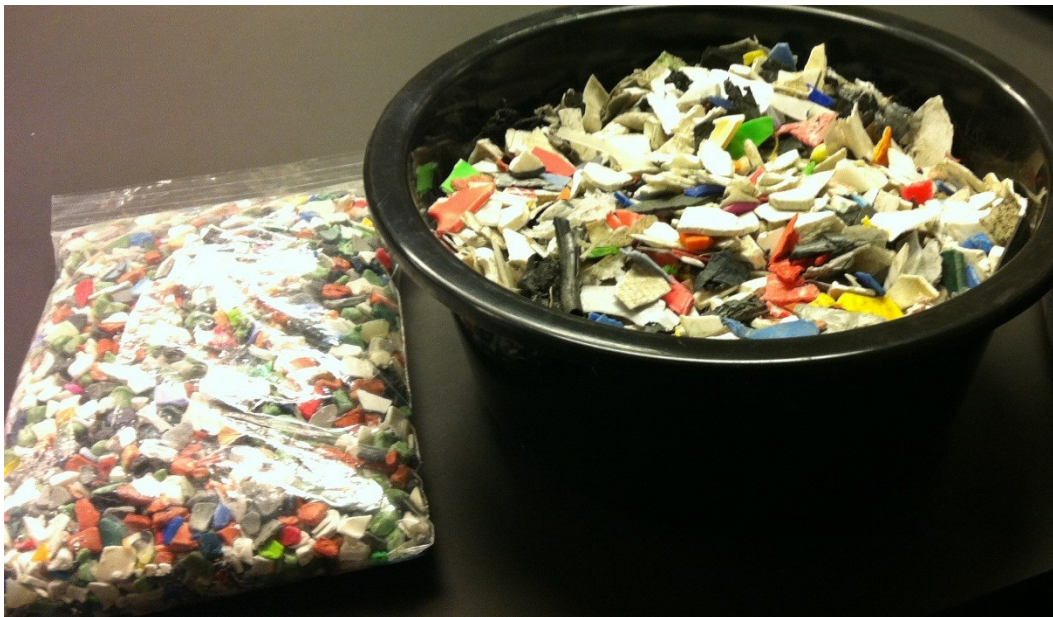
FIGUR 21 PRODUCERET 20 MM GRANULAT FRA DK RÅSTOF (HØJRE). 10 MM GRANULAT ER VIST TIL VENSTRE.
