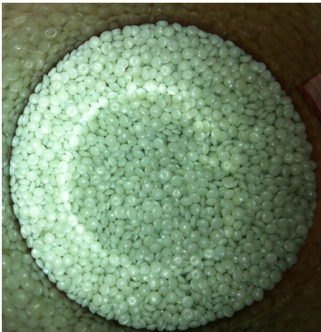
FIGUR 25 PRODUCERET REGRANULAT AF HDPE
