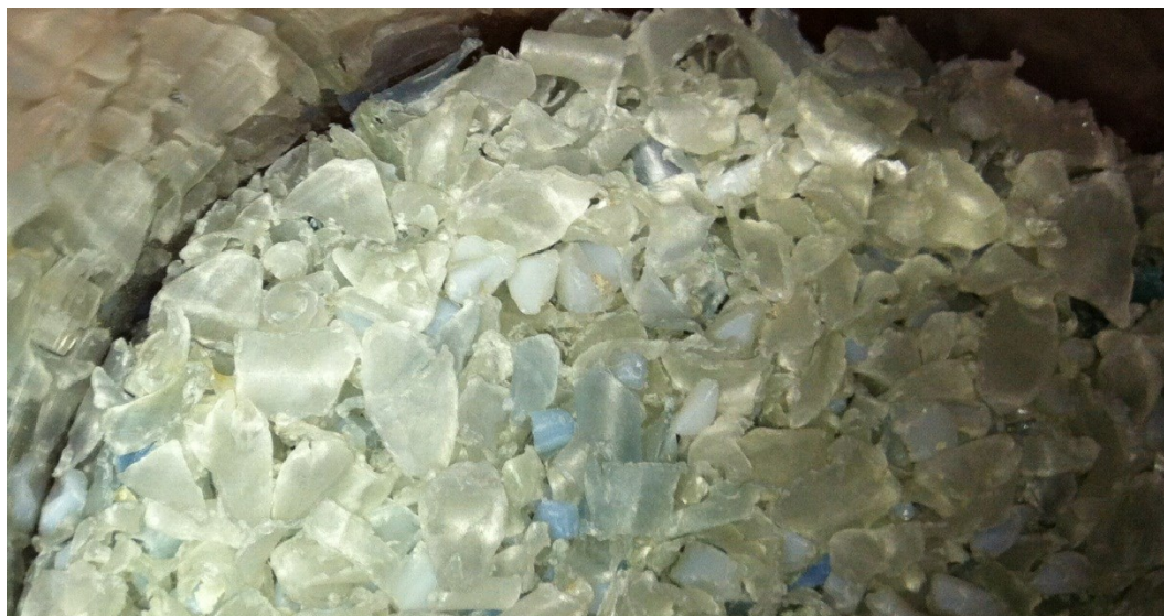
FIGUR 24 PRODUCEREDE FLAGER AF PET
