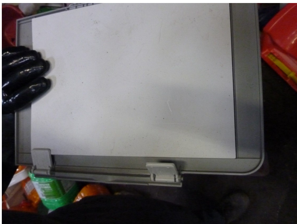
FIGUR 72 PLASTLÅG FRA PRINTER (KAN INDEHOLDE FLAMMEHÆMMERE)
