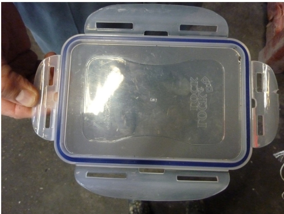
FIGUR 78 PLAST MED TERMOPLASTISK ELASTOMER
