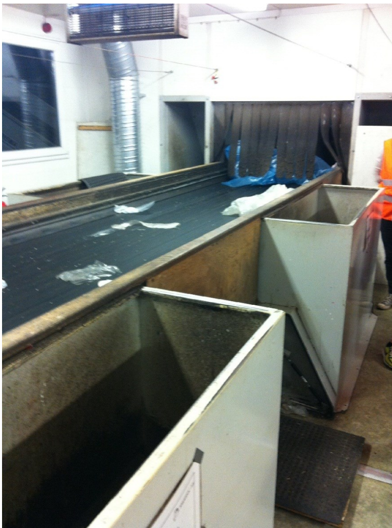
FIGUR 20 MANUEL EFTERSORTERING AF PLASTFOLIER
