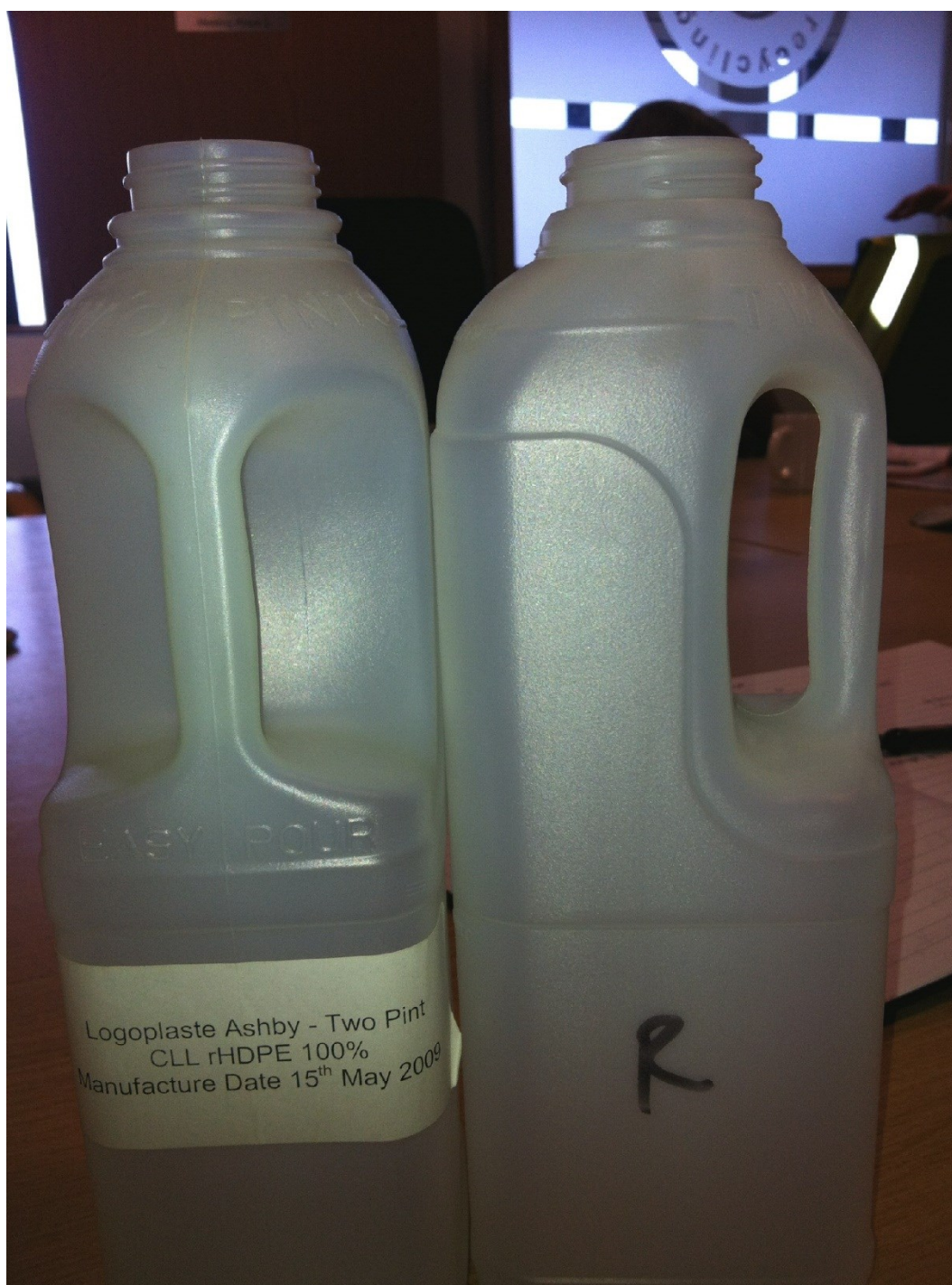
FIGUR 26 PRODUKTER AF VIRGIN HDPE OG MED REGRANULAT AF HDPE
