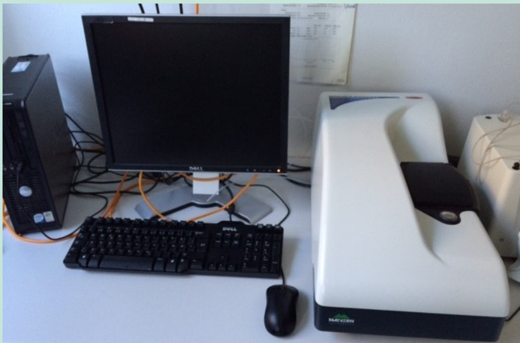
FIGUR 3 ZETASIZER NANO ZS FRA MALVERN INSTRUMENTS ANVENDT TIL DLS-MÅLING.
