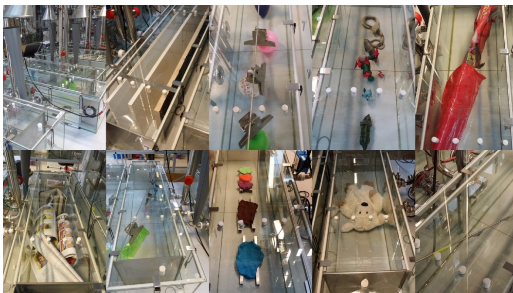
FIGUR 6.3. OPSÆTNING I CLIMPAQ-KAMRE. FRA VENSTRE, ØVERST: CLIMPAQ KAMRE HOS SBI, VÆG OG TRÆ MALING ANVENDT PÅ GIPSPLADER OG TRÆPLADE, BALLONER, GUMMIFIGURER, LEGETELT, TEGNESERIER, GUMMI STRAND-ARTIKLER, MODELLERVOKS, BAMSE, TAPE
