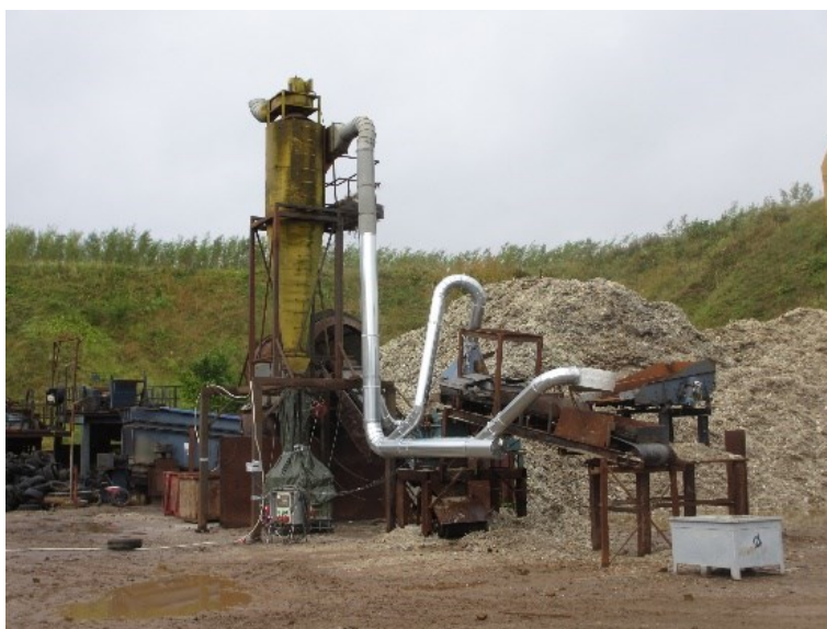
Opstillet proceslinje til fremstilling af glasfiber granulat
