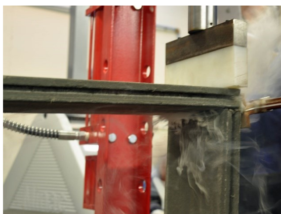
Forsøg med svejsning af hjørnesamlinger af plast
