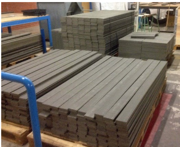
Profilér af ekstruderet plast; SP Extrusion
