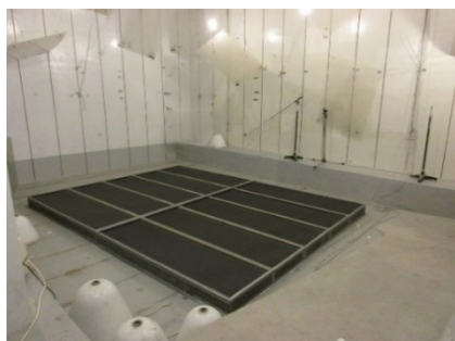
Udlægning af støjskærmsselementer
