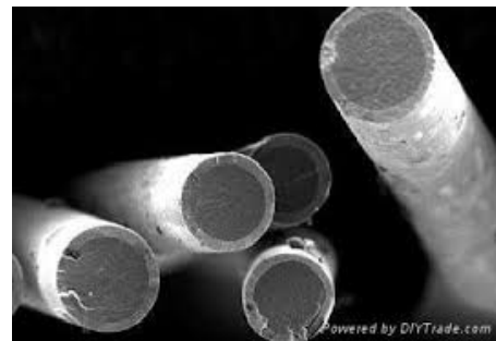
FIGUR 5: BI-COMPONENT (SHEATH-CORE) SOM BINDEMIDDEL
