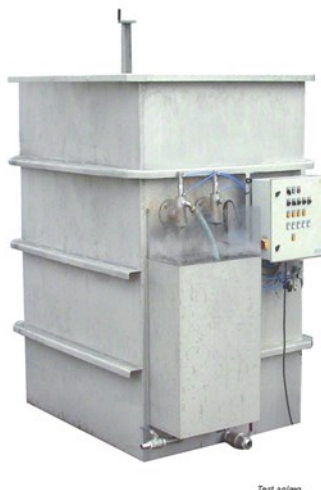
Figur 1 Test anlægget MBR KD 40 fra KD Maskinfabrik
