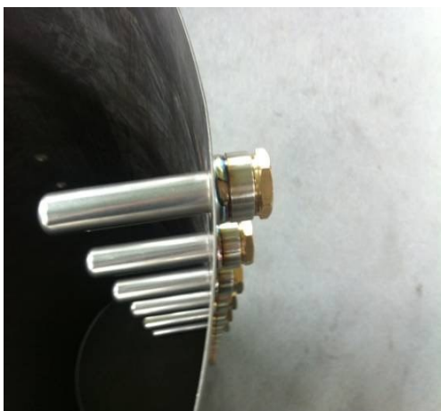
Figur 5 Disse indstik er særligt udviklet for netop varmeoverføring fra heat pipe rør. Heat pipens hoved stikkes ind i disse "fingerbøl" som omslutes af vandet, der skal opvarmes. Patenteret løsning, som kan købes billigt fra kinesisk producent.
