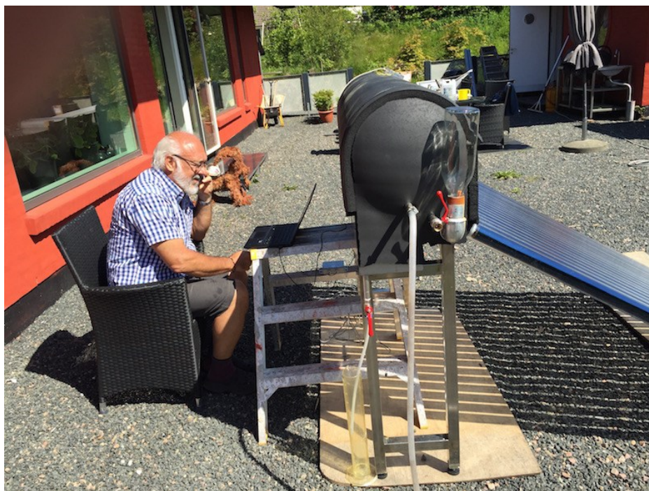
Figur 21 Afprøvning af enheden med solenergi på en af de sjældne solskinsdage. Den omvendte flaske er påfyldningen af fødevand til fordamperkarret, Det let gullige målebæger er til destillatet.
