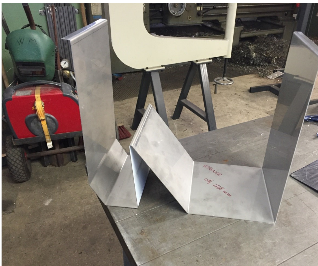
Figur 34 Model af enhedens bunddel. Til venstre ses fordamperskarret og til højre er karret for destillatopsamlingen. .
