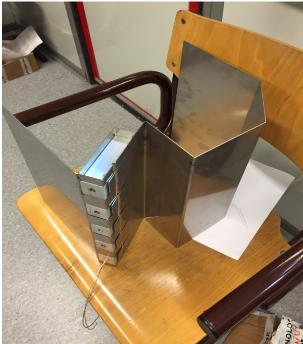
Figur 4 En funktionsmodel for varmeoverføring i form af tørt forbundne aluminiums-klodser, som fysisk forbundet med tyndpladen skal overføre varme. Hullerne er til små varmelegemer, som efterfølgende blev monteret.
