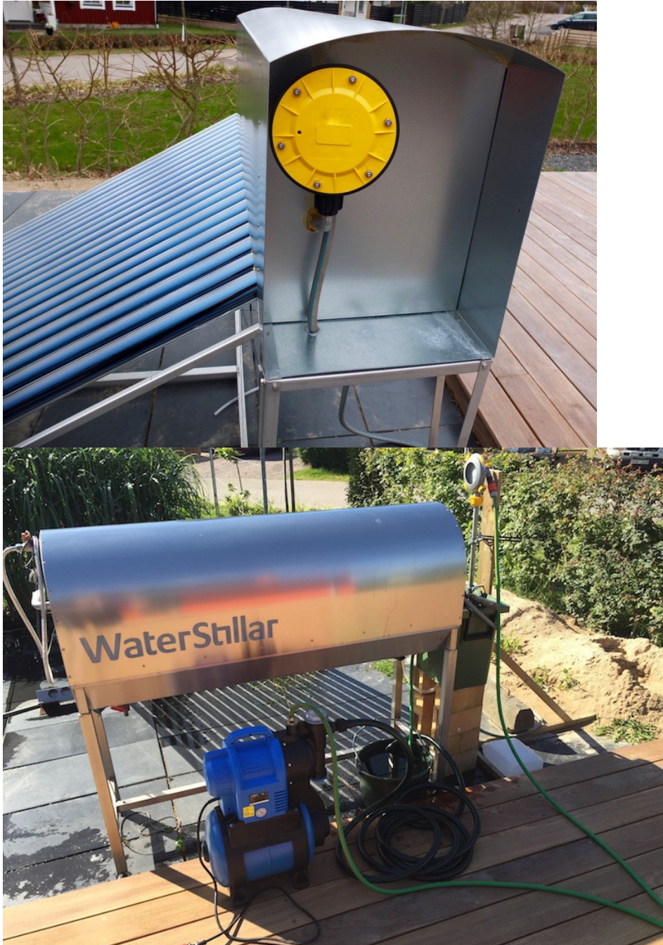
Figur 36 Specielt udviklet vakuumventil til enheden. Virker stabilt og vedligeholdet af ventilen kan klares på 5 min.
