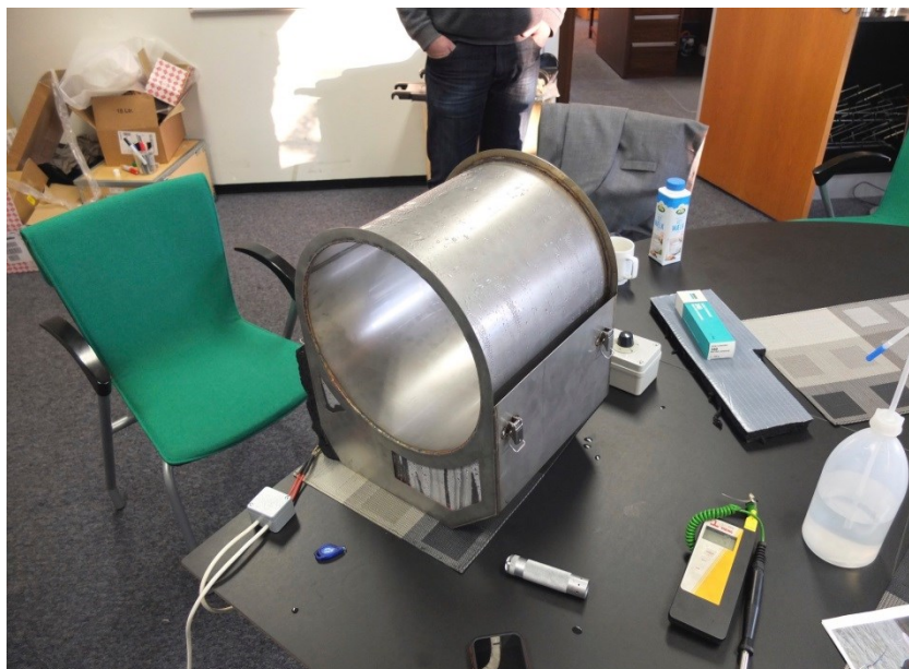
Figur 6 Funktionsmodel under opbygning. El varmelegemer, vinduer og temperaturfølere er monteret og det første destillat opsamles.
