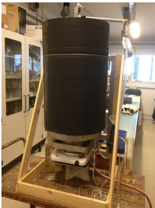
Figur 9 Prototype af WaterStillar Family til test af produktion ved elektrisk energi. Billedet er taget på DHI's laboratorium. Det varme brugsvand aftappes af røret for oven og destillatet tappes af i glas-målerøret til venstre, nederst.
