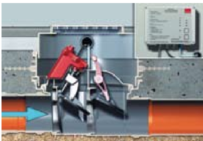
FIGUR 24 HØJVANDSLUKKE TYPE 3, DER ANVENDES TIL FÆKALIEHOLDIGT SPILDEVAND
