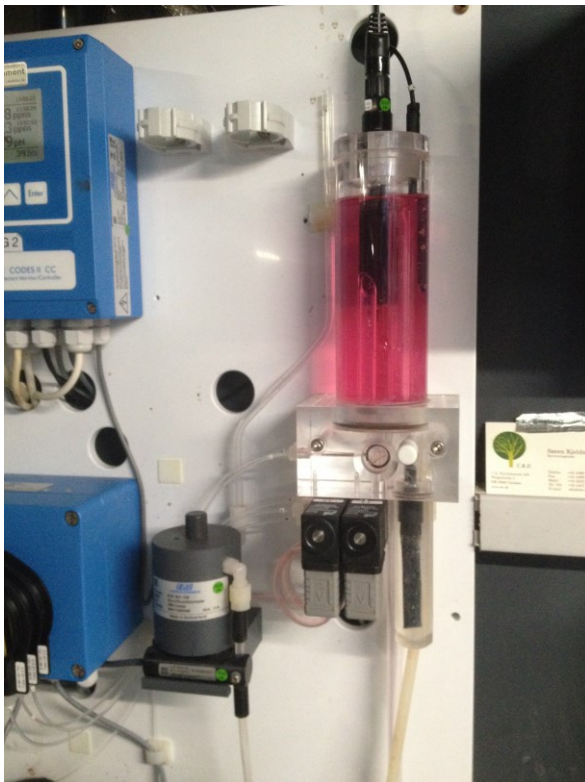
Figur 3.16 Sporstofforsøg til belysning af opblandingen i tilløbskammer til Codes-II CC
