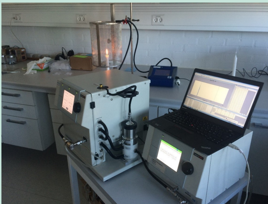
FIGUR 4 MÅLEOPSTILLING VED MÅLING AF PARTIKELEMISSION FRA LEVENDE LYS MED SMPS.
