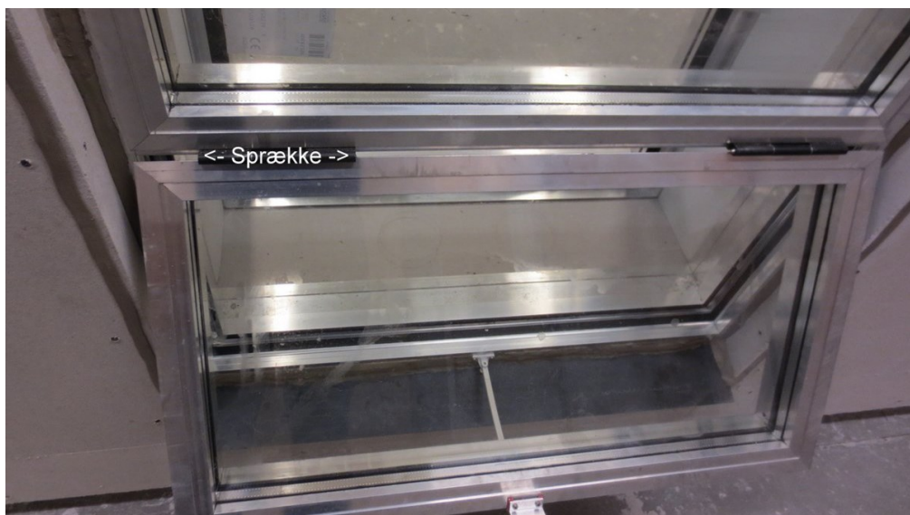
Illustration 10I. Foto fra laboratoriemålingerne taget fra udvendig side. Fotoet viser en sprække øverst ved oplukket, når oplukket åbnes.
