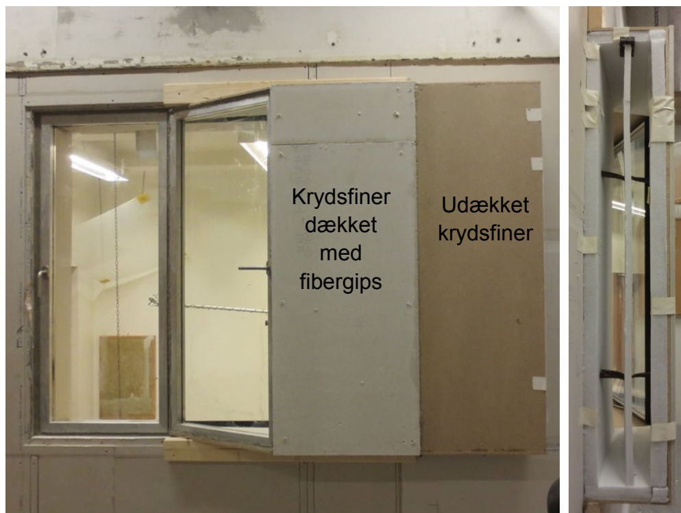
Illustration 9K. To fotos af mockup-løsning C. Venstre foto viser konstruktionen set fra udvendig side og viser den forlængede kasse (defaultlængden af kassen svarer til, hvor der er påsat fibergips (venstre side) og tilføjesen er, hvor krydsfinerpladen er synlig (højre side). Højre foto viser konstruktionen set fra den åbne ende med maksimalt tilføjet mængde absorption, dvs. 40 mm i top, bund og sider samt 20 mm i "midten".
