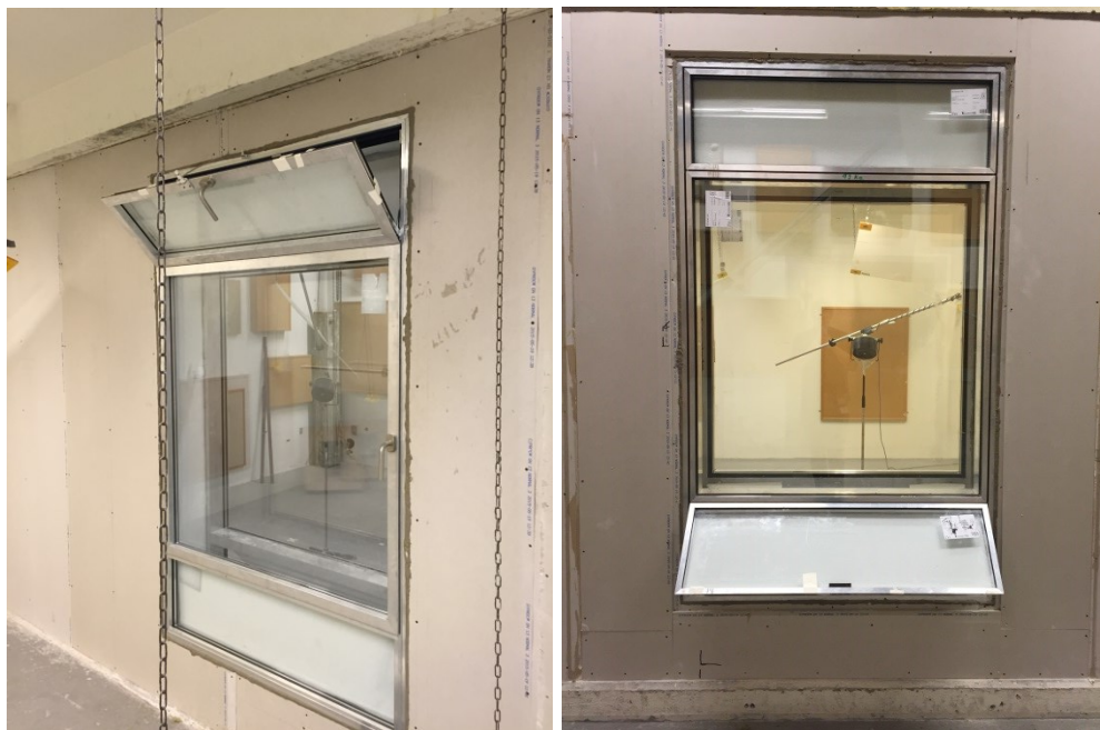
Illustration 7G. Venstre side: foto set fra indvendig side af absorbent på opluk og rude modstående opluk. Højre side: foto set fra udvendig side af absorbent på opluk og rude modstående opluk.
