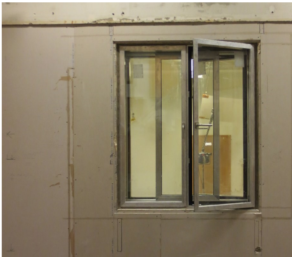
Illustration 8A. Prototypeløsning for "almindeligt vindue" med indvendig løsning.
