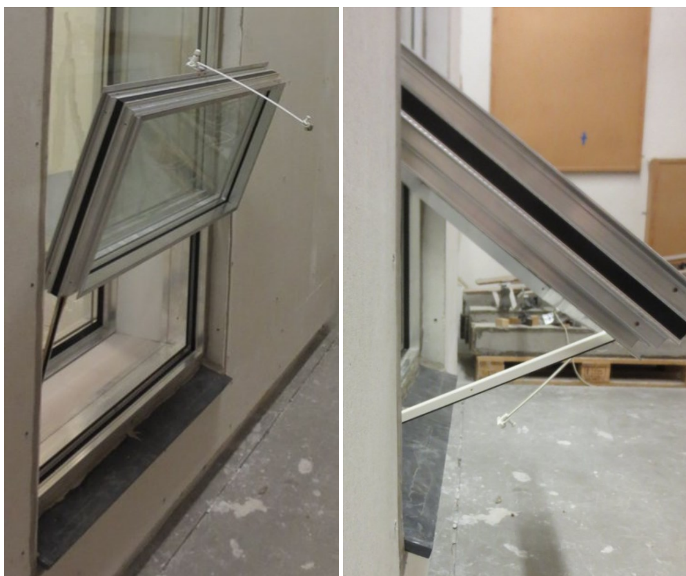
Illustration 10H. Foto fra laboratoriemålingerne taget fra udvendig side. Venstre foto viser oplukket åbent så meget som muligt, mens højre foto viser oplukket i en "skrå position". I begge situationer er åbningsarealet ca. 0,35 m 2 .
