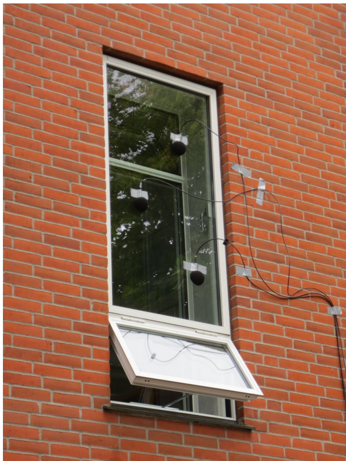
Illustration 10C. Foto fra feltmålingerne, hvor oplukkene er åbnet så meget som muligt. De tre mikrofoner er påsat ruden.
