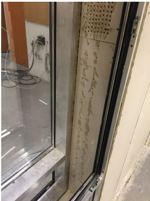
Illustration 7F. Foto af vinduet monteret med 34,91 % og 3,14 % perforeret karm hhv. øverst og nederst. Fotoet er taget ned mod bunden af vinduet.
