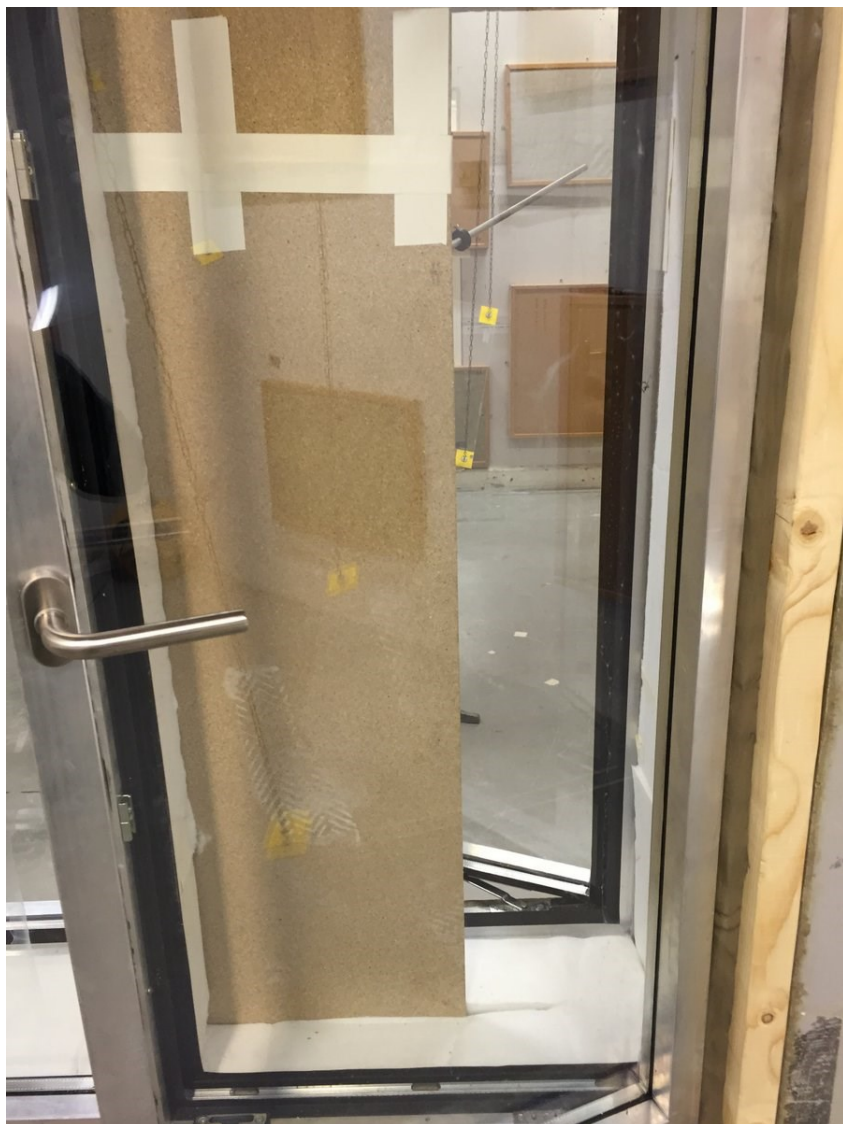
Illustration 81. Foto af tofløjet løsning under målingerne. Der kan ses absorber på midterpladen og i karmen (både i siden og i bunden), men ikke på den tværgående plade.
