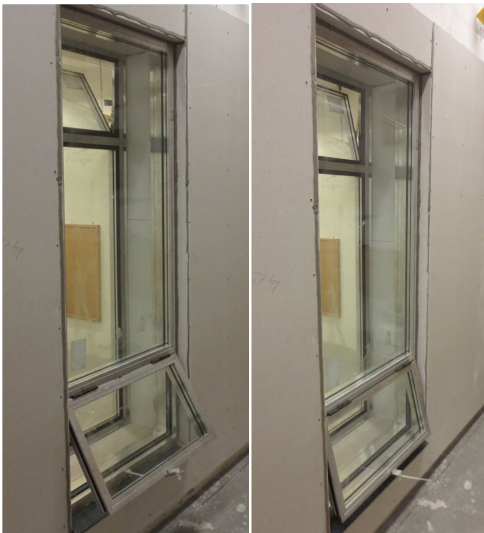
Illustration 10F. Foto fra laboratoriemålingerne taget fra udvendig side. Venstre foto viser oplukkene "helt åbne", mens højre foto viser oplukkene "4 cm" åbne.
