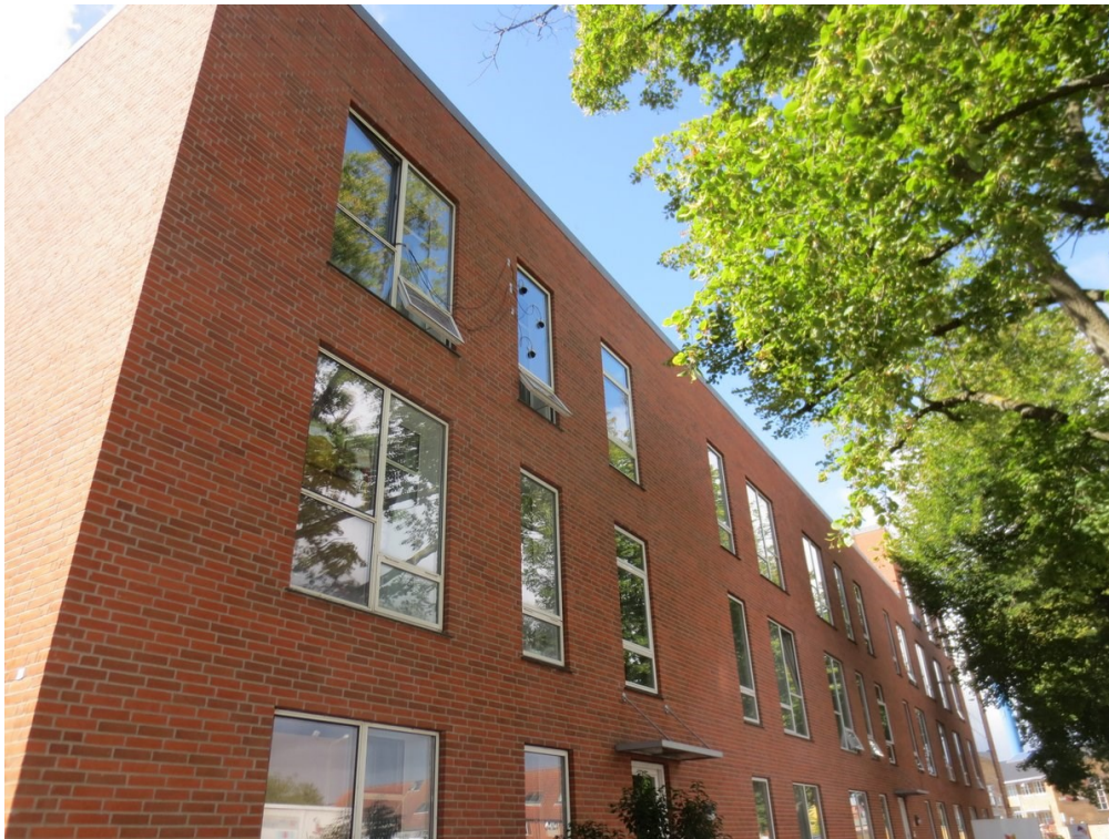
Illustration 10B. Foto fra feltmålingerne, hvor målingerne på 2. sal er under udførelse (vinduet er «helt åben»). 3 mikrofoner ses placeret på vinduet.
