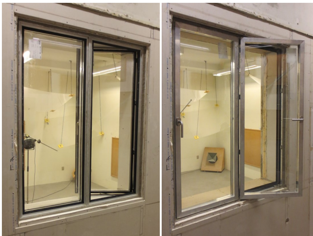
Illustration 9B. Fotos af de anvendte "almindelige vinduer". Venstre foto viser et tofløjet indadgående vindue, der er hængslet i siden. Højre foto viser et tofløjet udadgående vindue, der er hængslet i lodposten.
