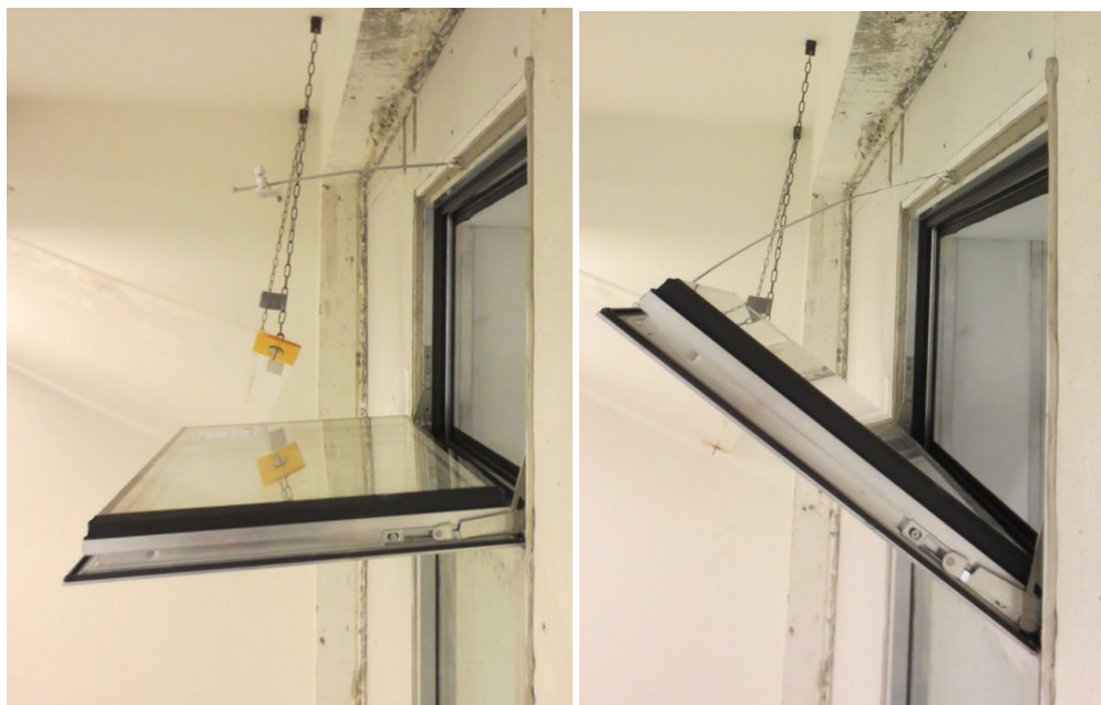
Illustration 10G. Foto fra laboratoriemålingerne taget fra indvendig side. Venstre foto viser oplukket åbent så meget som muligt, mens højre foto viser oplukket i en "skrå position". I begge situationer er åbningsarealet ca. 0,35 m 2 .
