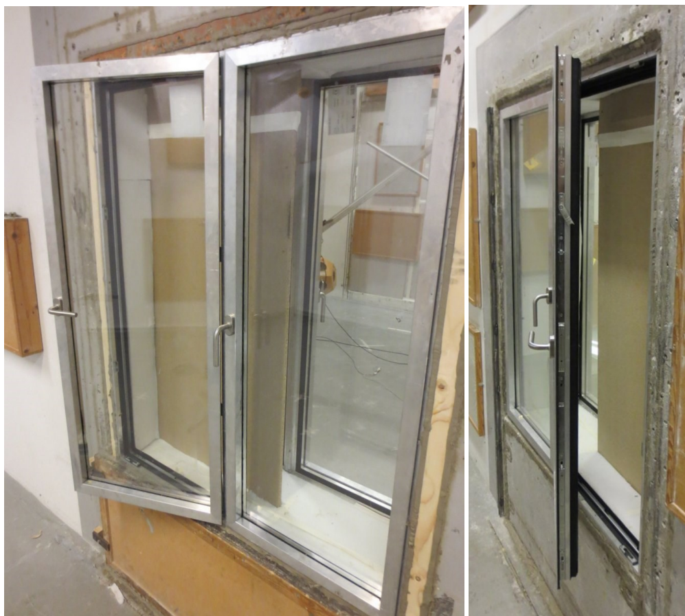
Illustration 8J. Fotos af den simulerede sidehængte løsning uden absorbent på tværpladen.
