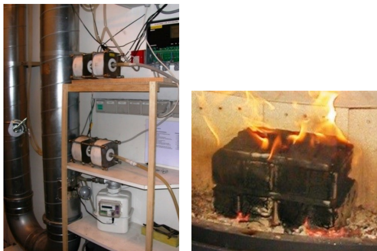
BILLEDE 5 MÅLEOPSTILLING TIL VENSTRE MED SAMTIDIG MÅLING AF EC-OC OG PM. TIL HØJRE DEN NORSKE PRØVEKLODS AF GRAN
