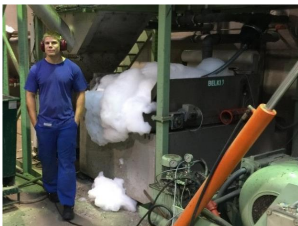
Figur 16: Skumdannelse i VSA anlæg ved behandling af PE-HUS
