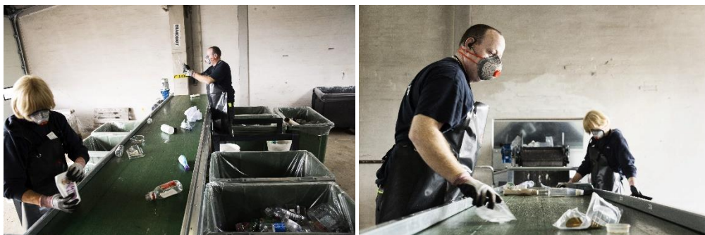
Figur 4: Manuel sortering af husstandsindsamlet plast. Foto: Christoffer Regild
