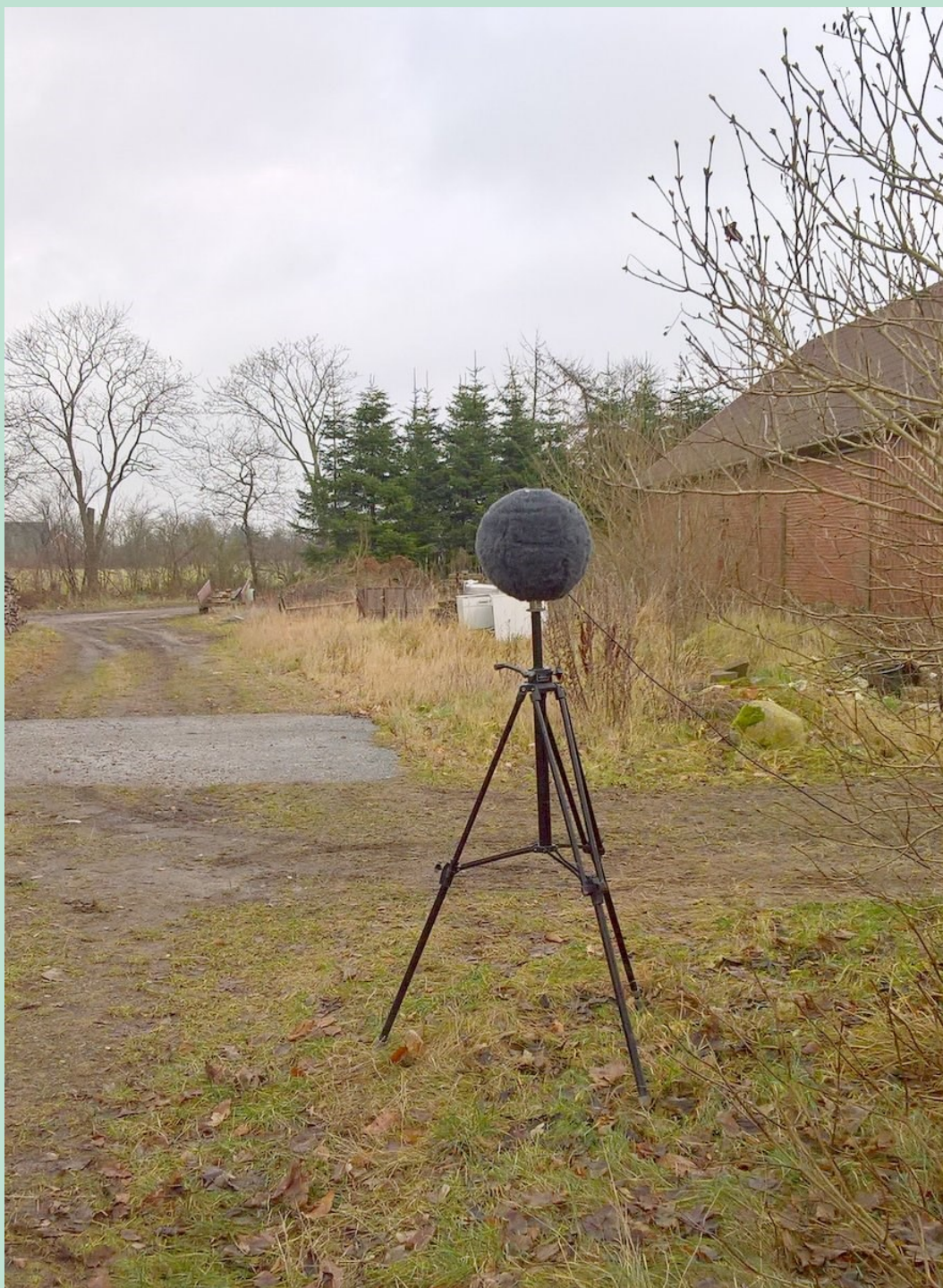
FIGUR 88. Endagsmålekampagne. Foto af mikrofonen placeret bagved bygningerne ved nabo mod sydøst – hjørne tættest på vindmøllerne. Foto mod øst.
