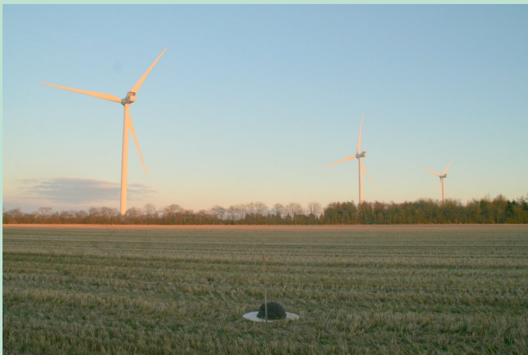
FIGUR 100. Foto af mikrofonen placeret mellem vindmølle WT3 og nabo mod sydvest. Foto mod øst.
