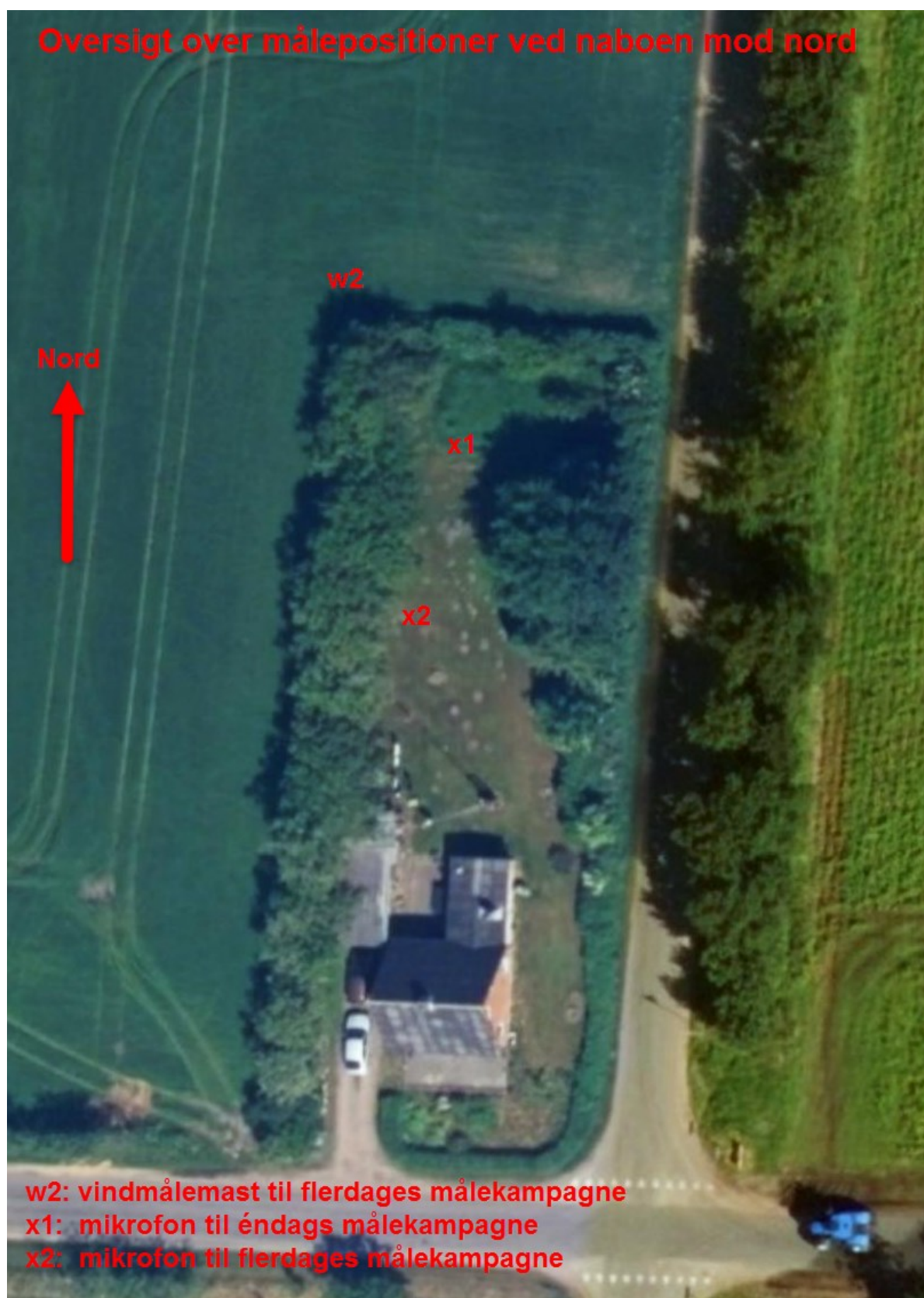
FIGUR 105. Oversigt over målesetup ved naboen mod nord. WT2 P3.
