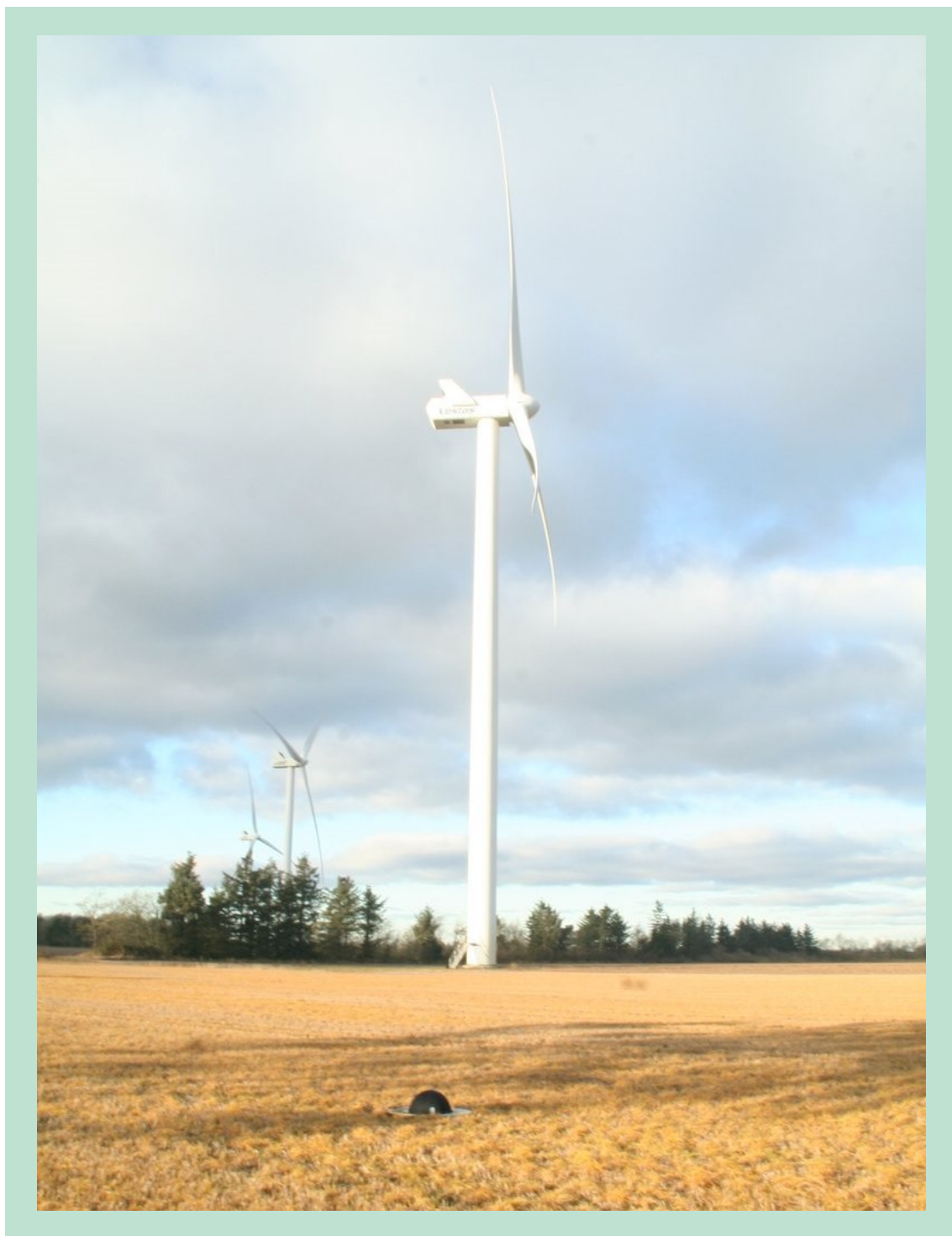
FIGUR 89. Foto af mikrofonen placeret tæt på vindmølle WT1. Foto mod nordvest.
