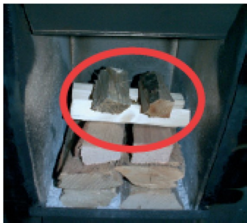
BILLEDE 32 BILLEDE FRA RAPPORTEN ILLUSTRERER OPSTILLINGEN AF TRÆET VED OPTÆNDING I TOPPEN.
