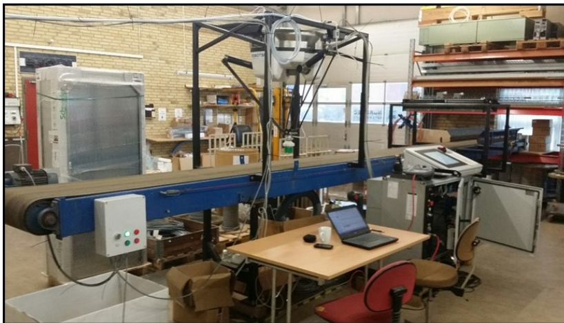
Foto 10.1 Indledende forsøgsopstilling med ABB Flexpicker ophængt i ramme
