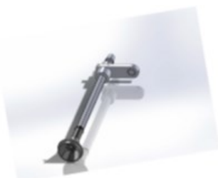
Foto 7.11 Detailtegning; griber med suger og fjeder
