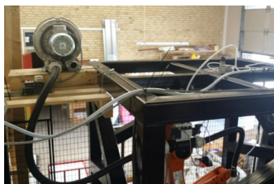
Foto 7.10 Sidekanalblæser; varm afgangsluft
