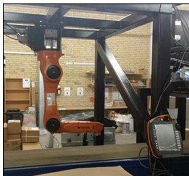
Foto 7.2 Ophængs-ramme i kraftigere materialekvalitet med Kuka robot
