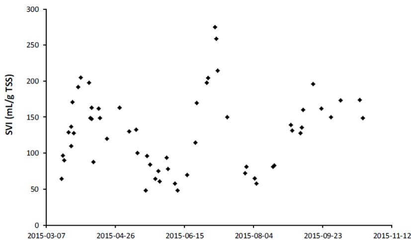
**FIGUR 8: Udviklingen i slamvolumenindeks af slammet i pilotanlægget i løbet af pilotforsøget**
