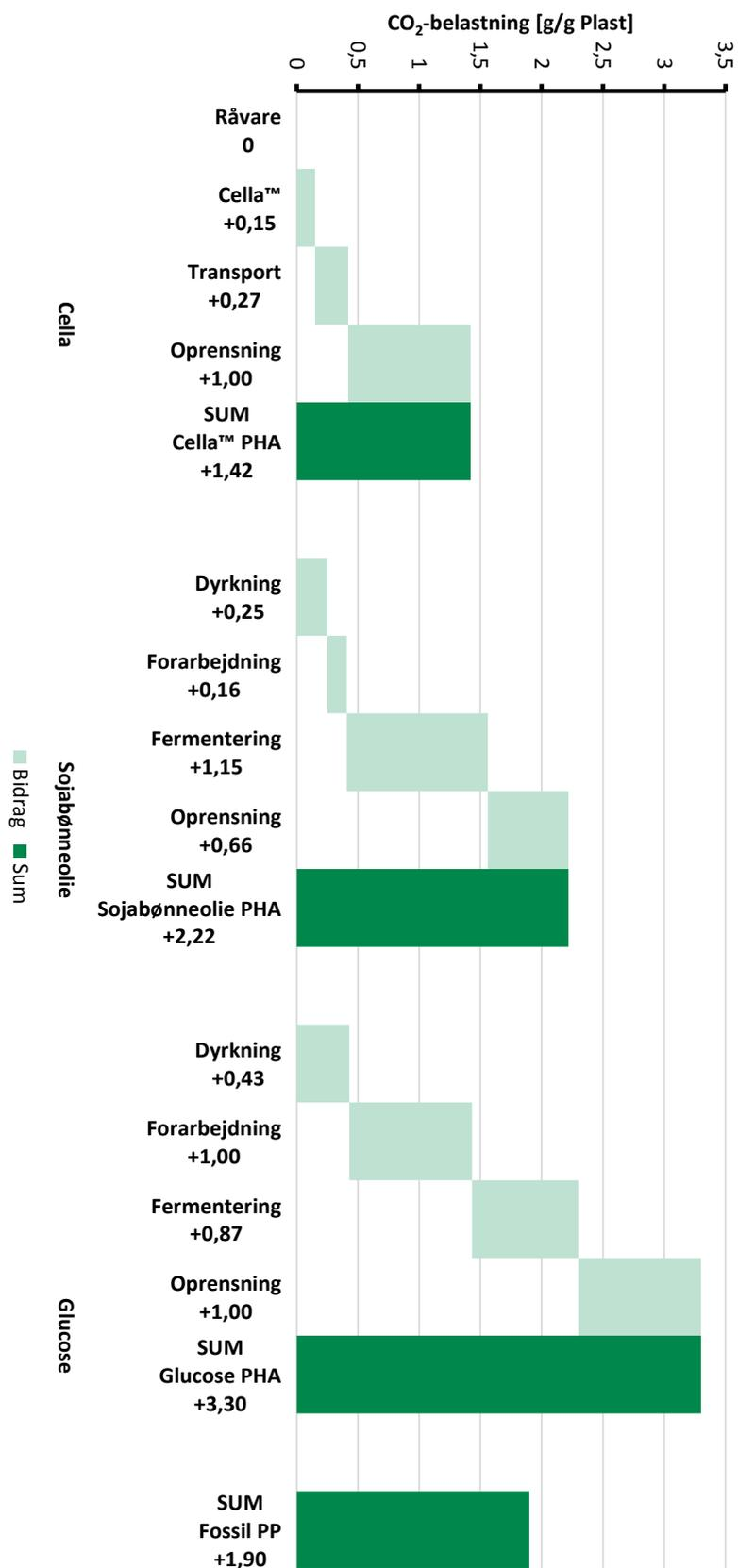
FIGUR 18: Sammenligning af CO<sub>2</sub>-belastning for 3 forskellige fremstillingsprocesser for PHA, samt fossilt baseret plastik med tilsvarende egenskaber.
