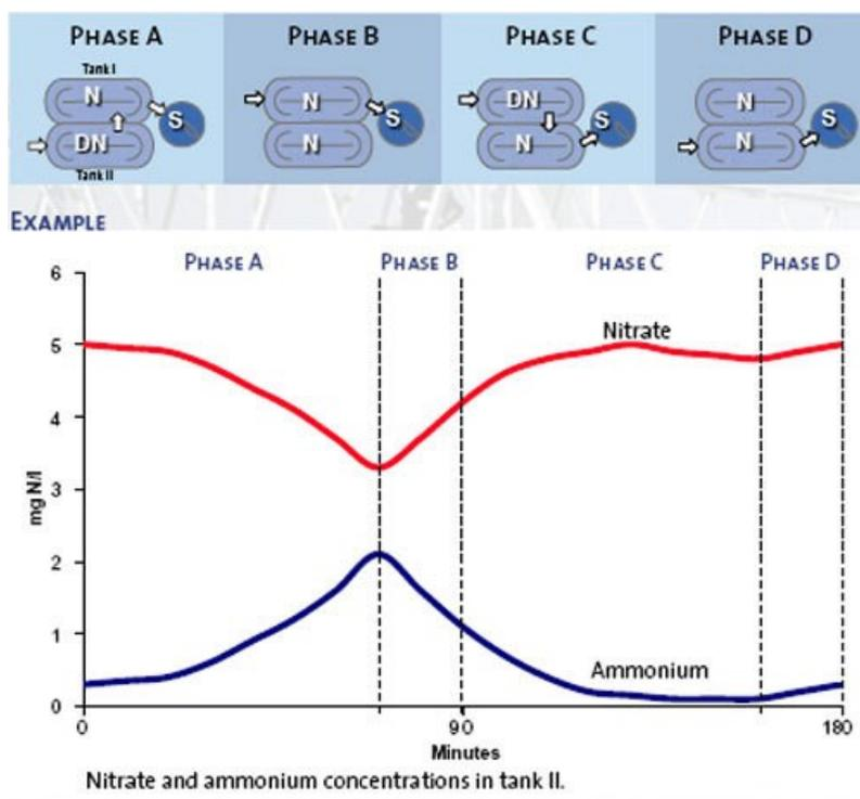
**FIGUR 14: Eksempel på driften af og koncentrationsudviklingen i tank II i Biodenitro-processen.**
