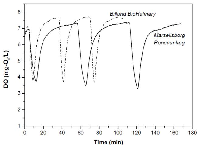
**FIGUR 11: Opløst ilt-profil (DO) for pre-akklimeringsprocessen for slam fra Billund BioRefinery (BBR) og Marselisborg Renselanlæg (MR).**
