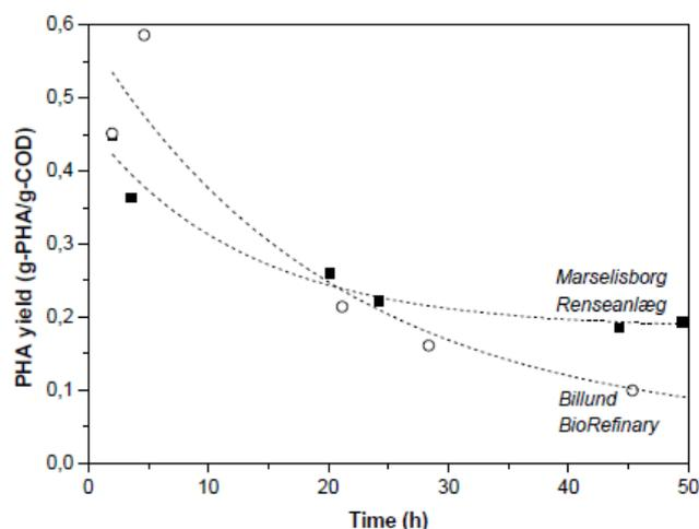
FIGUR 13: PHA-udbyttet som funktion af tiden.
