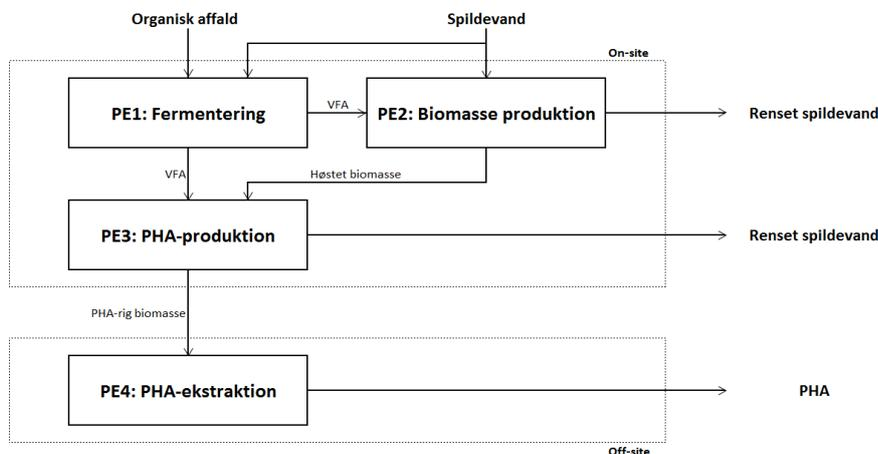
**FIGUR 3: Overordnet proces flow diagram for PHA-produktionen**
