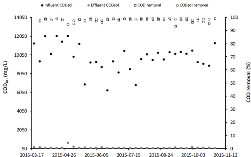
**FIGUR 7: COD-indhold i KMC's spildevand før (sorte cirkler) og efter (grå cirkler) spildevandsrensning i pilotanlægget samt COD-omsætning (hvide cirkler og firkanter)**
