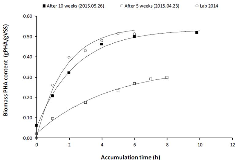
**FIGUR 9: PHA-udbytterne opnået med KMC's biomasse og spildevand efter 5 (hvide firkanter) og 10 ugers pilotforsøg (sorte firkanter) og PHA-udbyttet opnået med KMC biomasse og eddikesyre (hvide cirkler).**
