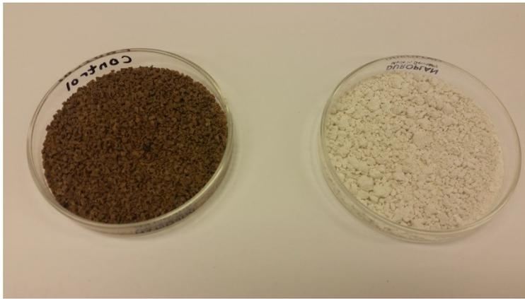
**FIGUR 2: PHA-rig biomasse og ekstraheret PHA**
