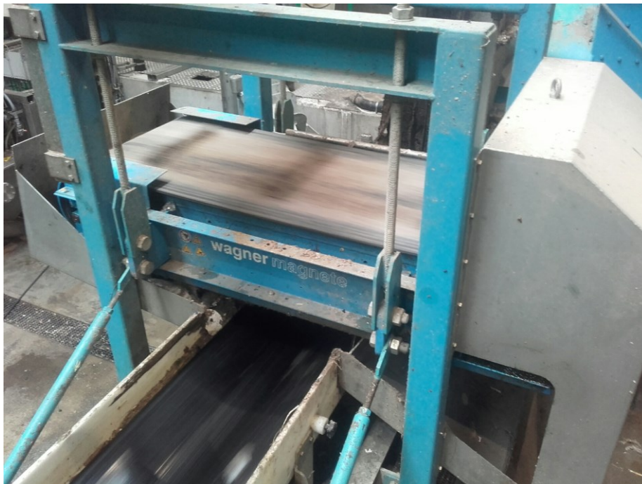
Billede af overbåndsmagnet for fraseparering af jern fra rejekt
