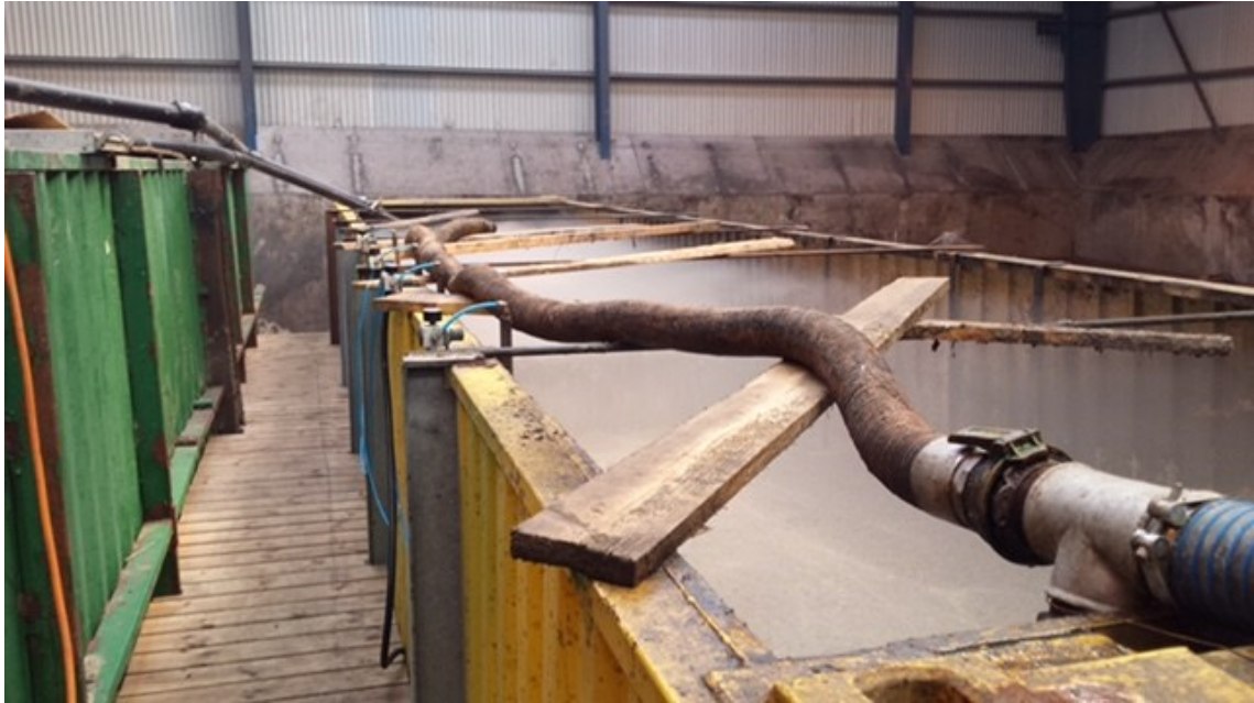
Sedimentationstanke blev også forsøgt anvendt til fraskilning af plast – plast svømmer ovenpå
