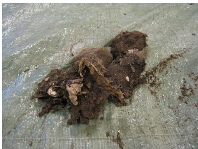
Figur 3.23: Eksempel på sammenfiltret "kage" som er blevet magnetisk på grund af indholdet af jernoxider
