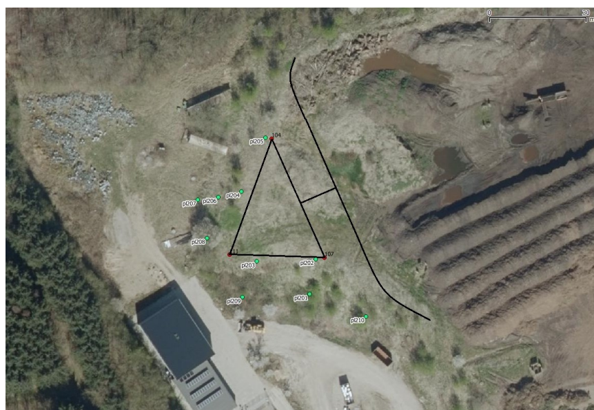
Figur 7.17 Placering af poreluftsonder, PL201-PL210, til måling af gas
