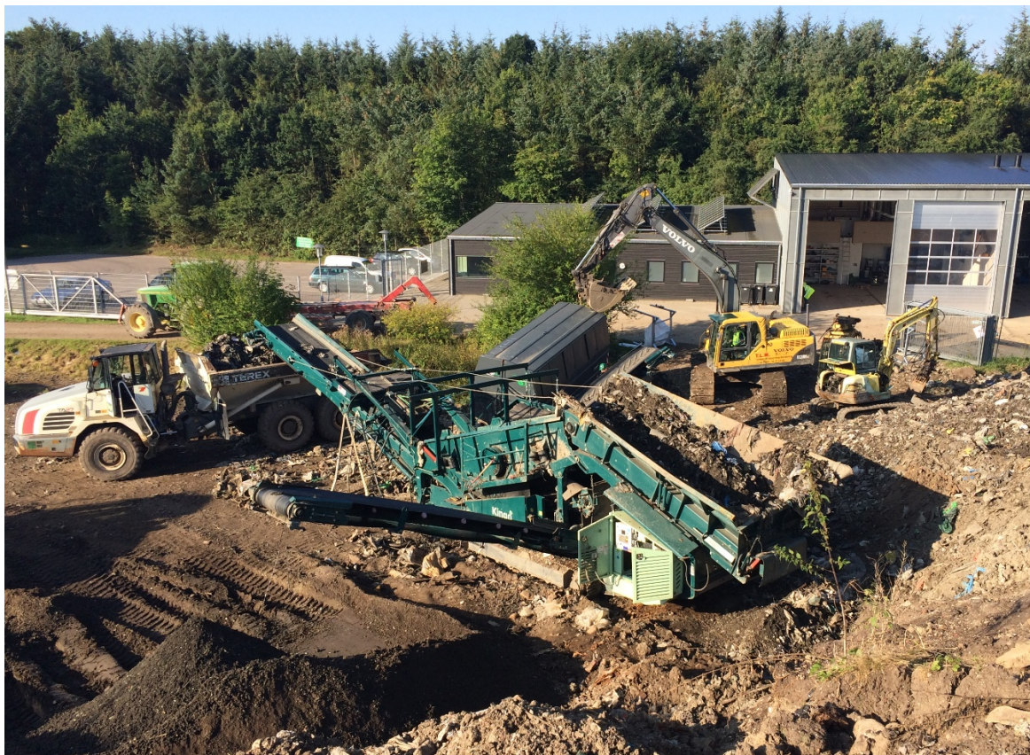
Foto 5. Kee-track sorteranlæg: Til højre indløbskasse (/fødekasse). I midten vibrationskasse med sold. Nærmeste udløbsbånd til venstre: finfraktion. Udløbsbånd til dumper: grovfraktion. Udløbsbånd til højre: mellemfraktion. Lukket container: lette plast folier fra plastsuger. Båndmagneter er ophængt over udløbsbånd for mellem- og grovfraktion.
