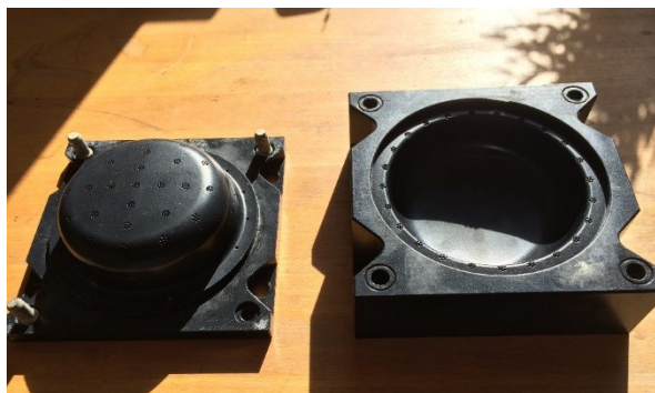
Figur 10: Efterpresformen til tørring og presning af emnet
