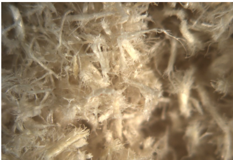
Figur 4: Defibrillated fibre. En mikroskopibillede af "fluffed" fibre for at illustrere den potentielle virkning af den mekaniske forbehandling, med særlig henvisning til den forbedrede defibrillation opnået.
