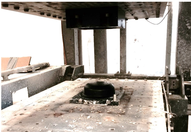
Figur 13: Efterpresværktøjer monteret på anlæggets varme planer
