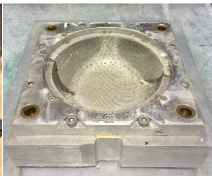
Figur 11: Netformen til at opsuge fibrene på før tørring
