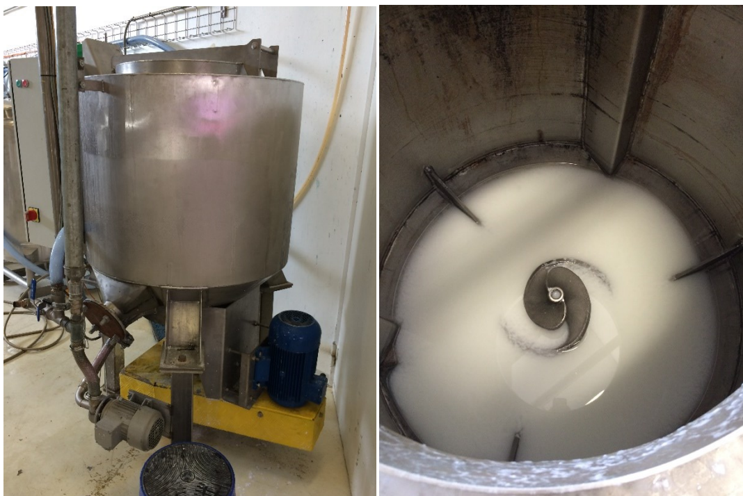
Figur 7: Til venstre, pulperen set udefra, Til højre, pulperen indeni set oppefra.
