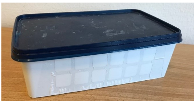
BILLEDE 2. Den sprøjtestøbte prototype (udenpå) med aktiv label og ikke-afskærmet låg (foto).
