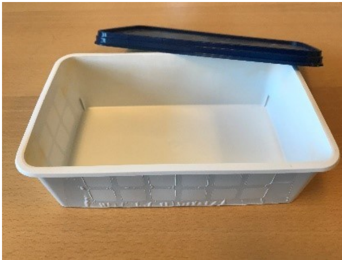
BILLEDE 4. Den sprøjttestøbte prototype (indeni) med aktiv label og ikke-afskærmet låg (foto).
