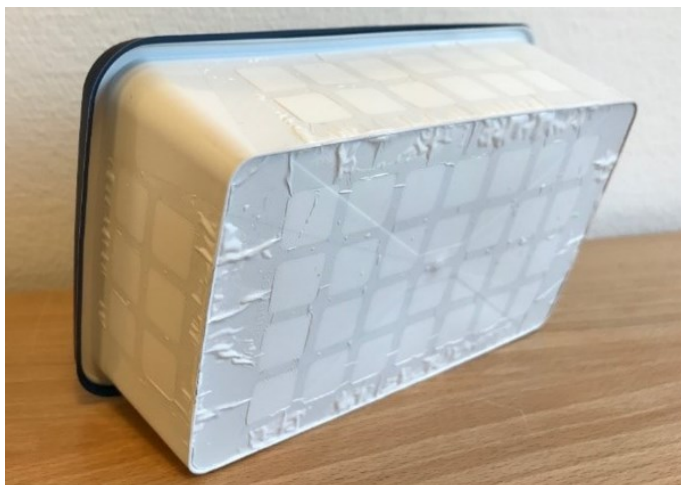
BILLEDE 3. Den sprøjtestøbte prototype (fra bunden) med aktiv label og ikke-afskærmet låg (foto).
