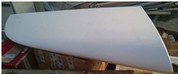
FIGUR 31. PONTON MED ISPRØJTET MATERIALE
