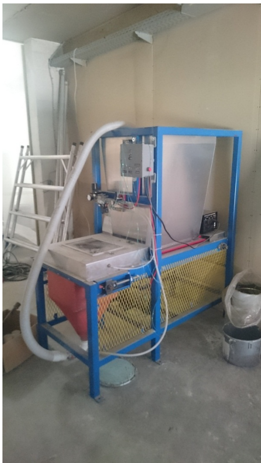
FIGUR 8. DOSERINGSANLÆG TIL RECYCLET MATERIALE
