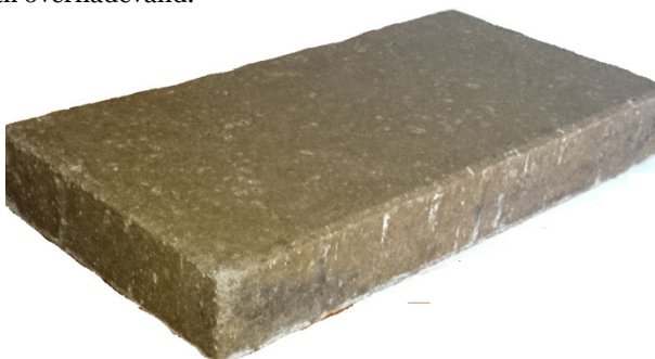
FIGUR 33: FLISE / STEN PRODUCERET I HÅRD FIBER BETON
