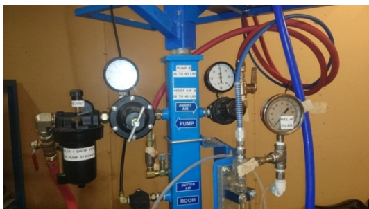
FIGUR 7. SPRAYSTATION TIL UDLÆGNING AF MATERIALE I PRODUKTION
