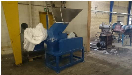
FIGUR 6. KNUSNINGSENHED TIL FINDELING AF MATERIALE
