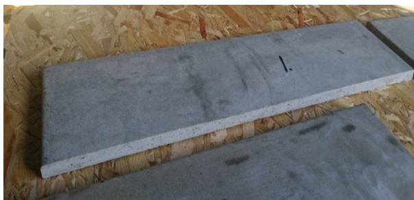
FIGUR 32: EKSEMPEL PÅ PLADE AF FIBERMATERIALE OG POLYESTER.
